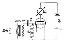
Abb. 93. Schaltung zur Messung des Audioneffektes.
