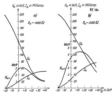
Abb. 57. Vergleichende Auffnahmen zu den Abb. 54a und b an einer RE 134.
