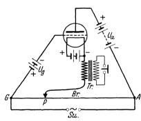
Abb. 12. Bestimmung des Durchgriffs in der Brücke.
