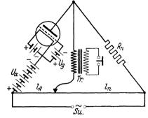
Abb. 13. Bestimmung des inneren Widerstandes in der Brücke.
