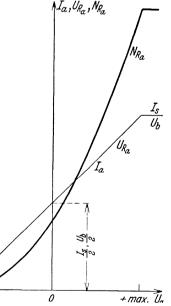
Abb. 47. Die Leistungsaufnahme des Anodenwiderstandes (dynamisch), nach Abb. 46 entworfen.
