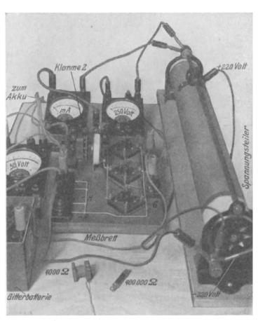
Abb. 16. Apparate der Meßanordnung.
