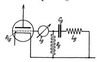
Abb. 76. Schaltanordnung zur automatischen Herstellung negativer Gittervorspannung für die Meißnersche Schaltung.
