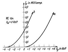
Abb. 23. Anlaufkennlinien des Gitterstromes bei Anlegen des Gitters, a) an den -- Pol, b) an den +- Pol der Heizbatterie.
