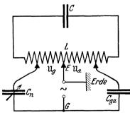
Abb. 68. Prinzip der Neutrodynschaltung.
