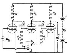
Abb. 36. Wechselspannungs-Dreifachwiderstandverstärker.
