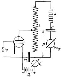
Abb. 60. In den Anodenkreis einer Röhre eingeschalteter (schwach) gedämpfter Schwingungskreis.
