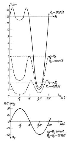
Abb. 55. Anodenverlustleistung (dynamisch) bei drei verschiedenen Ra, nach Abb. 54 entworfen.
