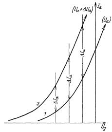
Abb. 11. Bestimmung des inneren Widerstandes  $R_i$ .
