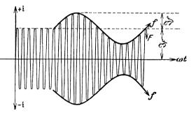
Abb. 80. Sinusförmig mit der Frequenz f modulierte Hochfrequenz F. f: F = 1:10;  $\Im_f: \Im_F = 1:2$ .
