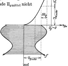
Abb. 88. Anodengleichrichtung bei hohen Gitterwechselspannungsamplituden.
