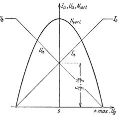
Abb. 44. Anodenverlustleistungsdiagramm (statisch).
