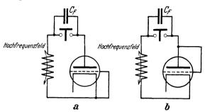
Abb. 85. Gleichrichterschaltungen der Röhre in Zweielektrodenschaltung (Fleming-Detektor.)
