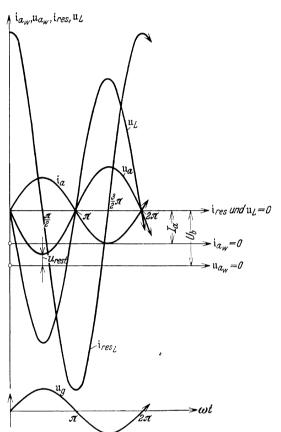
Abb. 63. Verlauf von Gitterwechselspannung, Anodenwechselspannung, Anodenwechselstrom, Spulenwechselspannung und Spulenwechselstrom (= Schwingkreisspannung und Schwingkreisstrom).
