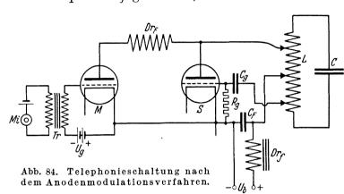
strömen verhindert; sie besitzt daher weit größere Abmessungen als die Hochfrequenzdrosselspule  $Dr._F$  und ist eine Eisenkernspule. Wird die Modulationsröhre M besprochen, so ändert sich ihr Anodenstrom im Sinne der Besprechung, d. h. sie gibt einen nieder-
