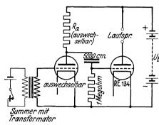
Abb. 53. Schaltanordnung eines Versuches zur Spannungsverstärkung.
