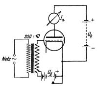
Abb. 92. Schaltung zur Messung des Richtstromes.
