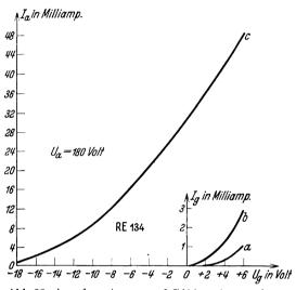
Abb. 22. Anodenstrom und Gitterstrom einer RE 134 bei positiven Gitterspannungen.
