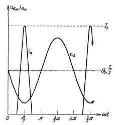
Abb. 62. Verlauf von Anodenwechselspannung und Anodenwechselstrom der Röhre bei Schaltungen nach Abb. 60; Schwingungen zweiter Art.
