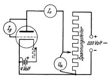
Abb. 24. Die Dreielektrodenröhre in Zweielektrodenschaltung.
