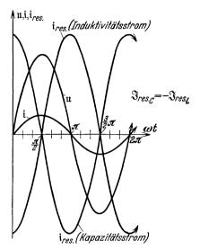
Abb. 59. Verlauf von Spannung, äußerem Strom i und Resonanzstrom i<sub>res.</sub> in Schwingungskreisen nach Abb. 58.
