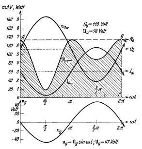
Abb. 74. Zeichnung des Anodenverlustleistungsdiagramms nach den Messungen der Tabelle 11 für  $z_a = 114$ .
