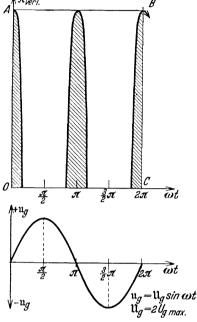
Abb. 48. Anodenverlustleistungsdiagramm (dynamisch) bei erhöhter Gitterwechselspannung unter sonst gleichen Betriebsbedingungen nach Abb. 44 u. 45. (Aussteuerung zweiter Art.)
