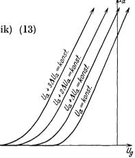
Abb. 8. Verschiebung der Charakteristik nach links mit wachsender Anodenspannung.
