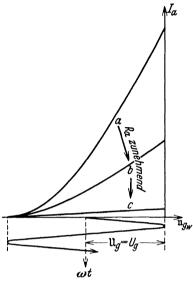
Abb. 41. Zunehmende Linearität und abnehmende Steilheit der Kennlinie mit wachsendem  $R_a$ .
