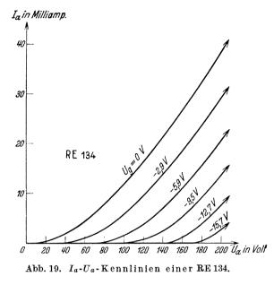
Röhren gleicher Type in dieser Weise in wenigen Minuten verglichen werden; es ergibt sich dann, daß eine völlige Gleichheit unter zwei Stücken kaum besteht.
