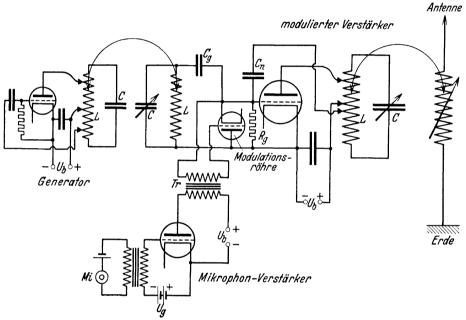
Abb. 83. Aufbau eines nach dem Gittergleichstromverfahren modulierten Rundfunksenders.
