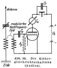
von einem anderen Hochfrequenzkreis im Empfänger) durch ein (hier sinusförmig) mit der Frequenz f moduliertes hochfrequentes Feld der Frequenz F erregt wird. Der Vorgang, der dadurch im Anodenkreis der Röhre ausgelöst
