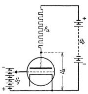
Abb. 32. Einschaltung eines Ohmschen Widerstandes in den Anodenkreis der
