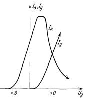
Abb. 9. Abnahme des Anodenstromes, Zunahme des Gitterstromes bei gesättigter Emission.
