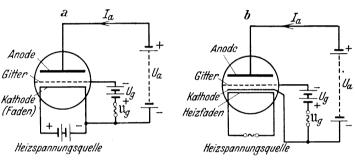
Abb. 4. Aufbau einer Dreielektrodenröhre a) mit direkt geheiztem Faden, b) mit indirekt geheiztem Faden.
