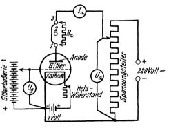
Abb. 15. Schema der Meßanordnung.
