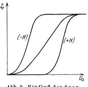
Abb. 3. Einfluß des Spannungsabfalls auf dem Heizfaden für die *I<sub>e</sub>*-Kurve.
