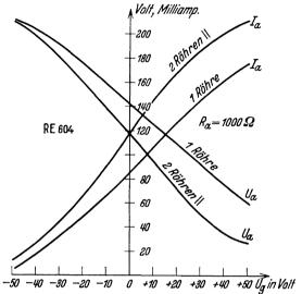
Abb. 56. Herabsetzung der Restspannung als Folge des Parallelschaltens von Röhren unter Beibehaltung des gleichen Anodenwiderstandes.
