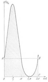
Abb. 46. Die Leistungsaufnahme des Anodenwiderstandes (statisch) unter Annahme des Anodenverlustleistungsdiagrammes nach Abb. 44.
