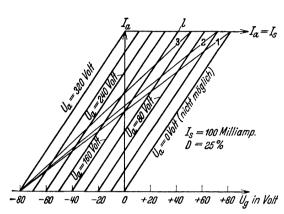
Abb. 43. Arbeitskennlinien bei Einschaltung Ohmscher Widerstände in den Anodenkreis der Röhre für verschiedene Aussteuerungszustände.
