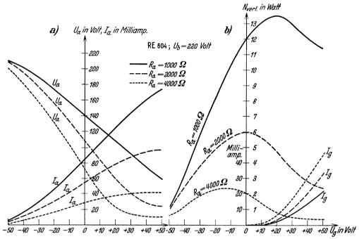
Abb. 54. a) Anodenstrom und Anodenspannung als Funktionen der Gitterspannung bei drei verschiedenen  $R_a$ ; b) Anodenverlustleistung (statisch) als Funktion der Gitterspannung bei drei verschiedenen  $R_a$ .
