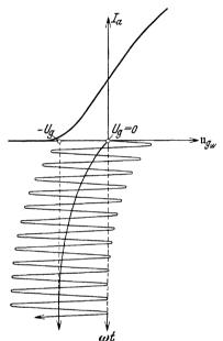
Abb. 67. Die automatische Erzeugung negativer Gittervorspannung durch einen Gittersperrkondensator nach Abb. 65a.
