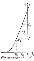
Abb. 7. Charakteristik einer Dreielektrodenröhre.
