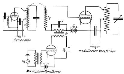
Abb. 82. Schaltung eines fremderregten Telephonie-Hochfrequenzgenerators mit Gitterbesprechung.
