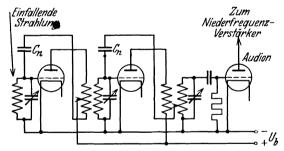
Abb. 70. Zweifach-Hochfrequenzverstärker in Neutrodynschaltung.
