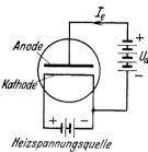
Abb. 1. Aufbau einer Zweielektrodenröhre.
