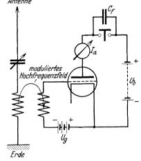
Abb. 86. Schaltung eines Richtverstärkers.
