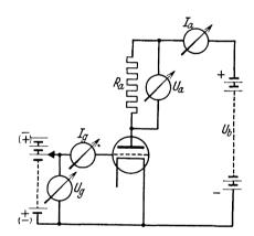
Abb. 51. Schaltanordnung zur Messung der Anodenspannung bei eingeschalteten Anodenwiderständen  $R_a$ . (Statt  $U_a$  schreibe  $U_{R_a}$ .)
