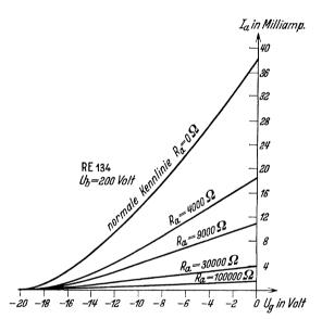
Abb. 50. Abnehmende Steilheit der Kennlinie einer RE 134 durch Einschaltung von Anodenwiderständen.
