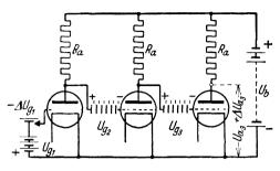
Abb. 35. Gleichspannungs-Dreifachverstärker.
