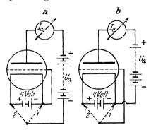
Abb. 27. Schaltanordnung zum Nachweis des Einflusses der Heizspannung auf die Steuerspannung.
