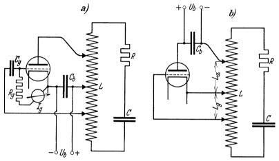
Abb. 65. Spannungsteilerschaltung. a) Spule hat Gleichspannung gegen Erde, das Gitter muß durch Kondensator geschützt werden; b) Spule ist über  $-U_b$  geerdet, der Gitterkondensator kann fortfallen.
