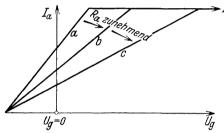
Abb. 42. Zunahme der Gitterspannung mit wachsenden Anodenwiderständen bei vollständiger Ausnutzung der Emission (Sättigungsgrenze).
