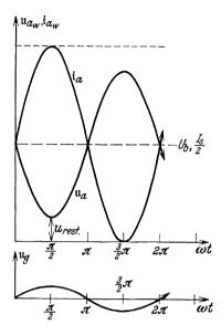
Abb. 61. Verlauf von Gitterwechselspannung, Anodenwechselstrom und Anodenwechselspannung der Röhre bei Schaltungen nach Abb. 60; Schwingungen erster Art.
