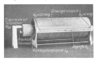
Abb. 72. Schwingkreisspule und Rückkopplungsspule der zu den Messungen des Abschnitts 3 benutzten Anordnung.
