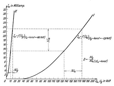
Abb. 20.  $I_a$ - $U_a$ -Kennlinie (I) und normale Kennlinie (II) einer RE 134, in gleichem Spannungsmaßstab gezeichnet.
