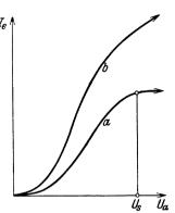
Abb. 2. Verlauf der Charakteristik einer Zweielektrodenröhre a) mit Wolframfaden, b) mit Bariumfaden.
