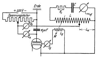
Abb. 73. Schaltanordnung zu den Messungen der Tabelle 11 (Rückkopplung nach Meißner, Abb. 64).
