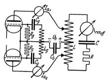
Abb. 71. Gegentaktschaltung in der Rückkoppelungsschaltung nach Meißner mit Schaltmitteln zur automatischen Herstellung negativer Vorspannung.
