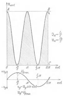
Abb. 45. Anodenverlustleistungsdiagramm (dynamisch), nach Abb. 44 entworfen.
