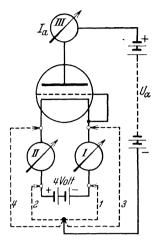
Abb. 29. Schaltung zur Untersuchung der Anodenstromverteilung auf dem Faden.
