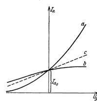
Abb. 78. Anodenstromkennlinien a) bei unterspannter und b) bei überspannter Röhre.
