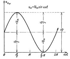
Abb. 33. Grenze der Amplitude der Anodenwechselspannung.
