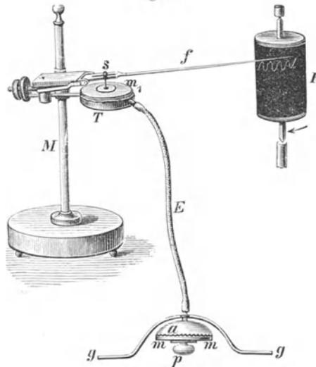
Cardiograph. *g* Gestell, das an der Brustwand durch Heftpflaster befestigt wird. *p* Pelotte, die auf die Stelle des Spitzenstosses gesetzt ist. *m* Gummimembran. *a* Luftkapsel. *E* Luftschlauch. *T* Marey'sche Kapsel mit der Membran *m*<sub>1</sub> und dem Stift *s*, der den Schreibhebel *f* in Bewegung setzt. *M* Stativ. *R* Berusste Schreibtrommel.
