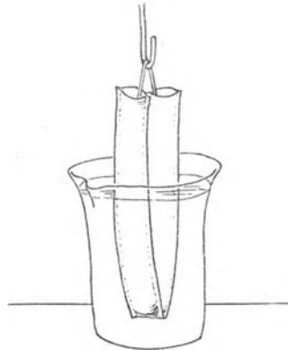
Dialyse. Eine Schlinge von Pergamentschlauch ist mit einer mit Salzen verunreinigten colloidalen Lösung gefüllt und in ein grosses Becherglas mit reinem Wasser gehängt. Die Salze gehen durch die Wand des Schlauches ins Wasser über, die colloide Lösung bleibt rein zurück.
