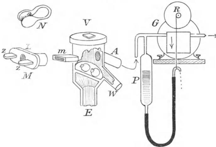
Respirationsapparat von Geppert-Zuntz. *N* Nasenklemme. *M* Mundstück mit Lippenplatte *L* und Zapfen für die Zähne *z z*. *V* Ventil. *m* Ansatz für das Mundstück. *E* Einathmungsrohr. *A* Ausathmungsrohr. *W* Wassersack. *G* Gasuhr. *R* Rolle. *P* Proberöhre.
