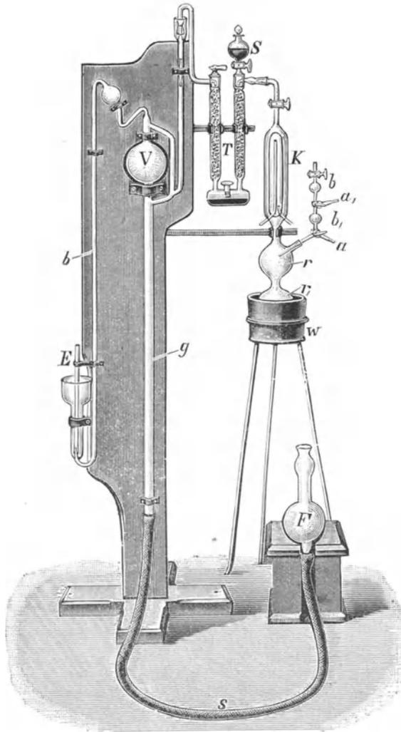
Blutgaspumpe nach Töppler-Hagen, modificirt von Zuntz. *F* Quecksilberflasche, durch deren Hebung und Senkung der Recipient *V* leergepumpt wird. *T* *S* Trockenflaschen. *K* Kühler, *r*, Gefäß zur Aufnahme der Blutprobe, in den Wassertopf *W* von 40° gesenkt. *aa*, *bb*, Hähne zur Füllung und Entleerung. *r* Gefäß zur Aufnahme des entstehenden Schaumes.
