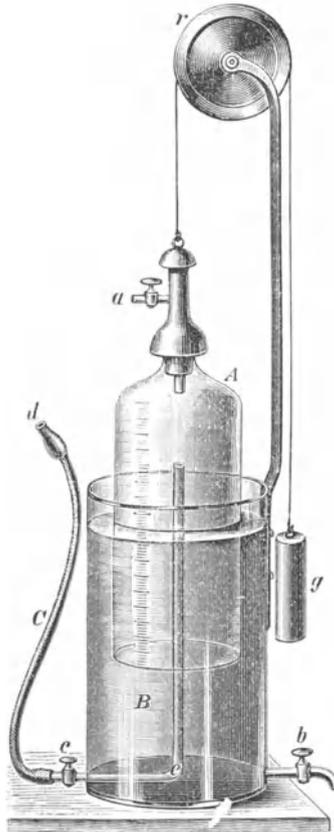
Spirometer. *B* Wassergefäss. *A* Glocke. *C* Zuführungsschlauch. *e* Zuführungsrohr mit Hahn. *d* Mundstück. *a* Hahn zum Entleeren der Glocke. *b* Hahn zum Ablassen des Wassers. *r* Rolle. *g* Gegengewicht.
