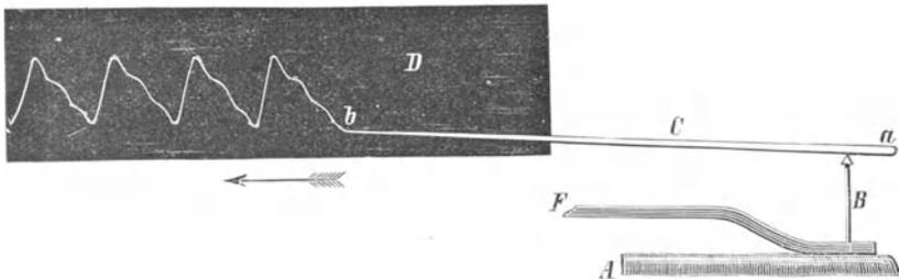
Schema des Sphygmographen von Marey. A Arterie, F federnde Pelotte, B Uebertragungstift, C Schreibhebel, a Drehpunkt, b Spitze, D durch Uhrwerk bewegte berusste Tafel.
