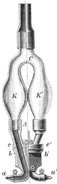
Ludwig's Stromuhr. Die linke Hälfte der Stromuhr ist im Durchschnitt gezeichnet. Der Gummischlauch oberhalb von C dient zum Füllen, und wird beim Versuch verschlossen. aa' Cantilen, die in das Gefäss eingeführt werden. bb' und cc' drehbar aufeinander aufgeschlossene Messingplatten. Die punktirte Linie AC deutet die Axe an, um die die Gefässe KK' beim Auswechseln gedreht werden.
