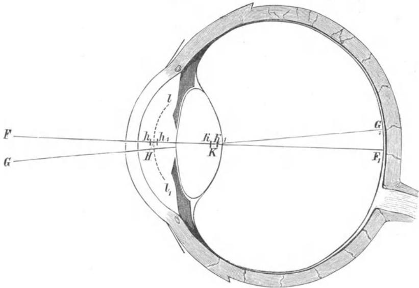
Schematisches und reducirtes Auge.
