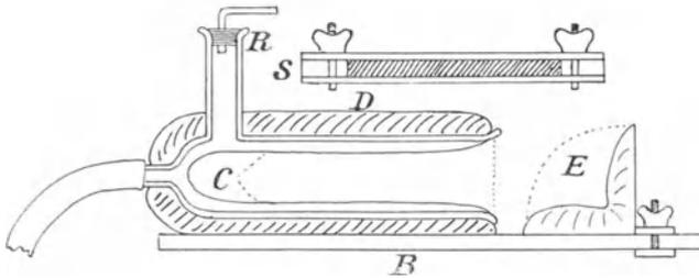
Plethysmograph neuerer Form. Schematisch. *B* Bodenbrett. *C* Gummibeutel im Innern des Glasgefässes, das zum Schutz gegen Temperaturschwankungen mit einer Hülle *D* umgeben ist. Die gepolsterte Stütze *E*, die in der bei *S* angegebenen Weise am Bodenbrett festgeschraubt werden kann, nimmt den Ellenbogen der Versuchsperson auf. *R* Ansatzröhre.
