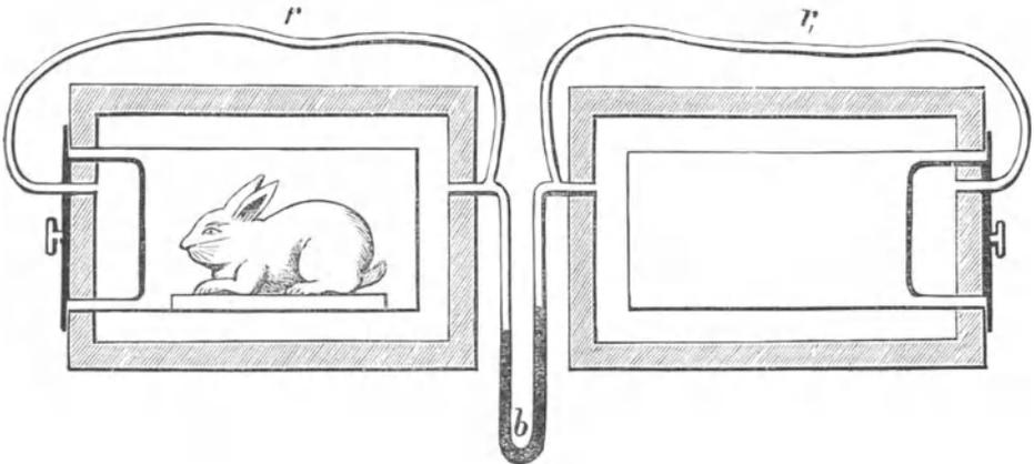
Luftcalorimeter mit Differentialmanometer.
