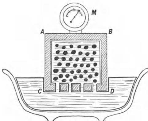
Schema eines Versuches über osmotischen Druck. *CD* eine halbdurchlässige Wand. *M* Manometer.
