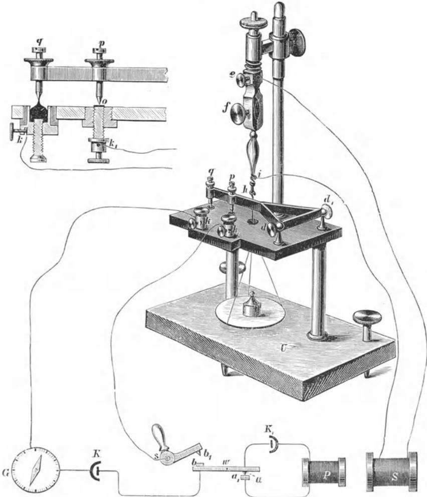
Froschunterbrecher. (Die am unteren Rand der Figur dargestellte Anordnung bezieht sich auf einen Versuch, der erst in einem weiter unten folgenden Abschnitt beschrieben ist.)
