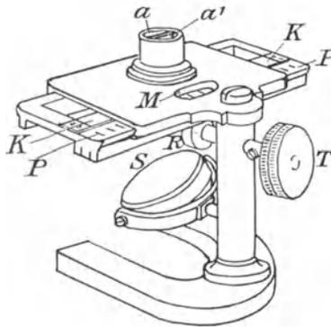
Haemometer. *K* Glaskeil, *T R* Trieb, *S* Gipsplatte, *P P* Theilung, *M* Marke, *a a'* Behälter für Blutlösung und Wasser.
