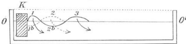
Schematische Darstellung der Wasserwellen in einem Troge.  $OO'$  Wasseroberfläche,  $K$  Klotz.
