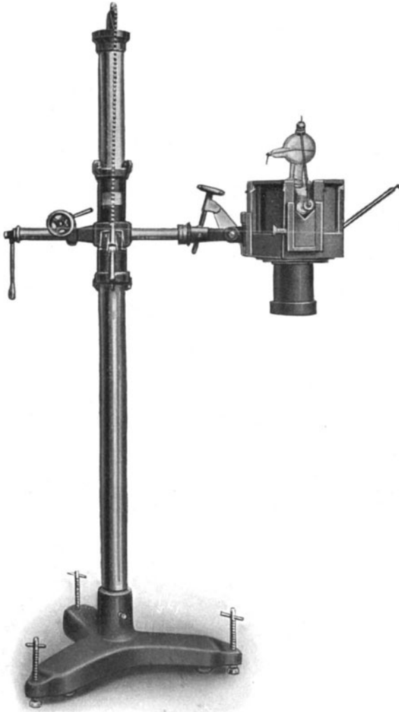
Abb. 85. Fahrbares Stativ mit zylindrischem Blenden- ansatz.
