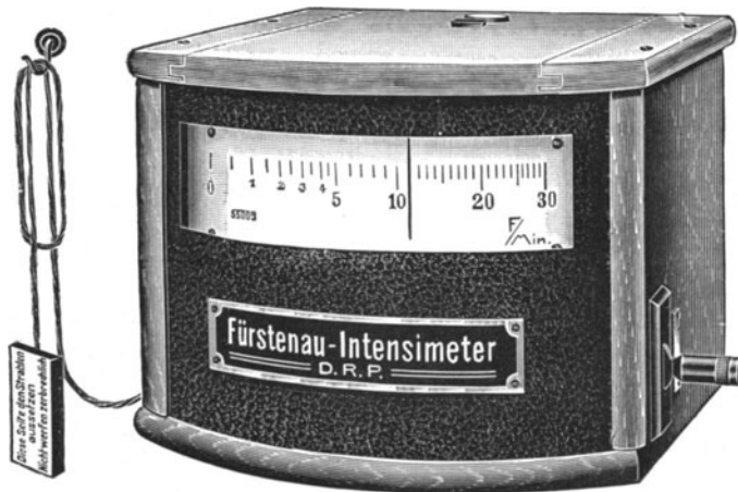
Abb. 66. Intensimeter nach Fürstenaus.
