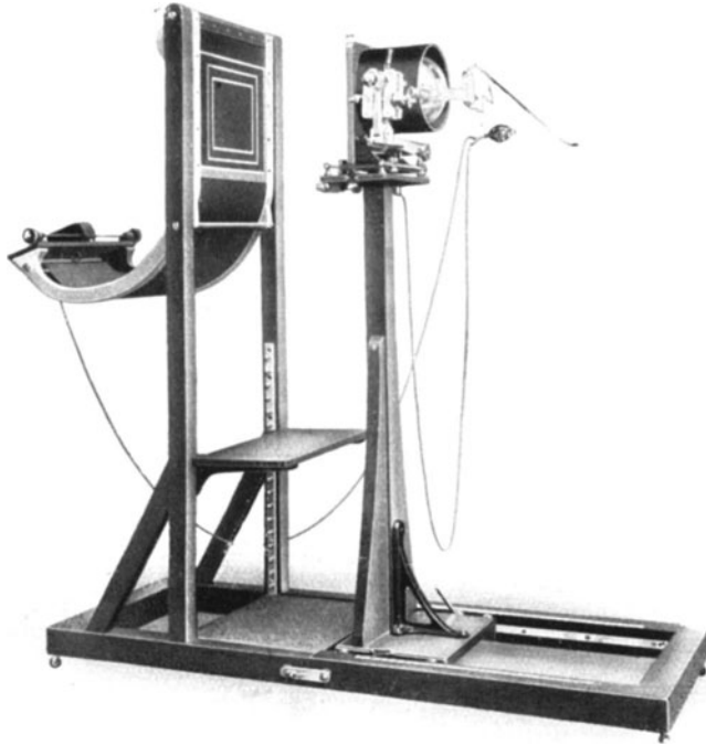
Abb. 94. Einfache Vorrichtung für stereoskopische Röntgenaufnahmen nach Franz M. Groedel, bestehend aus fester Kassettenstützwand mit Kassettenwechsellvorrichtung, zwei Kassetten mit Sinegranschirmen 30 \times 40 cm, in Höhe verstellbarem Sitzbrett; dazu in Rahmenführung verstellbarem Röhrenstativ mit strahlensicherem, seitlich um die Entfernung der Augenbasis verschiebbarem Schutzkasten einschließlich einem selbstzentrierenden Röhrenhalter und mit pneumatischer Betätigung der Vorrichtung für den Kassettenwechsel und die Röhrenverschiebung.
