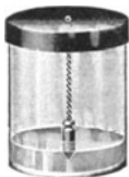
Abb. 81. Das inmitteneines im Deckel des Glases angebrachten Bleiringes aufgehängte Senkblei ragt — zur Schwingungsdämpfung — in Öl.
