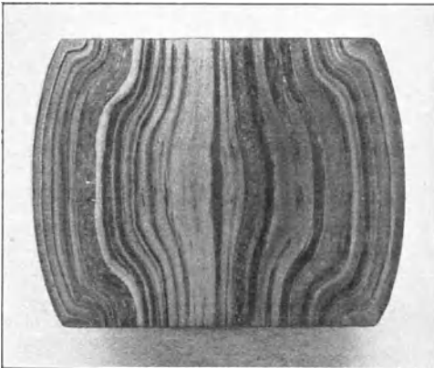
Fig. 22. Druckprobe aus Schweißbleisen, metroskopisch geätzt.
