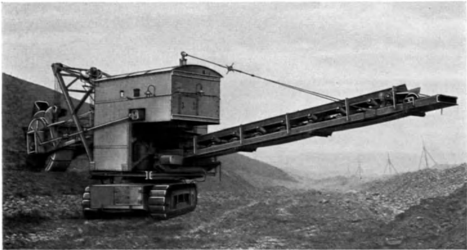
Abb. 76. Schaufelradbagger auf Raupen. (Maschinenbau-Anstalt Humboldt, Köln.)
