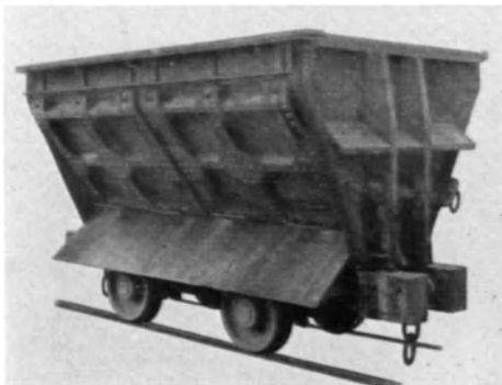
Abb. 34. 4,3-cbm-Selbstkipper für Felsbetrieb. (Krupp-Grusonwerk, Magdeburg.)
