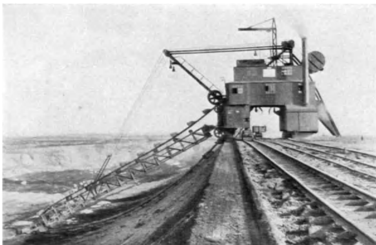
Abb. 65. Eimerkettenbagger der Lübecker Maschinenbau-Gesellschaft, Lübeck, (Einfachschütter) mit 250 Ltr. Eimerinhalt, Dampfantrieb.
