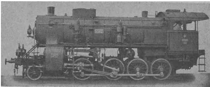
Abb. 140. Güterzuglokomotive mit quer über dem Rahmen angeordnetem Speisewasservorwärmer und Dampfspeisepumpe. J. A. Maffei.
