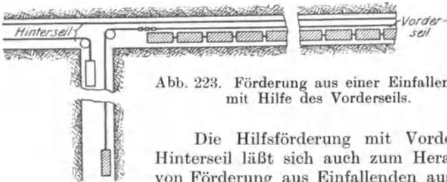
Abb. 223. Förderung aus einer Einfallenden mit Hilfe des Vorderseils.
