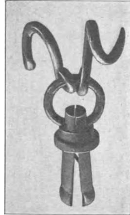
Abb. 339. Mitnehmerzange für Unterseilförderung.
