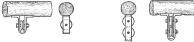
Abb. 218. Einfache Firstenrolle. Abb. 219. Doppelte Firstenrolle.
