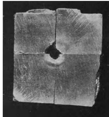
Bild 28. Durchschlagsloch bei Stoßspannung. 1,5fach vergrößert.
