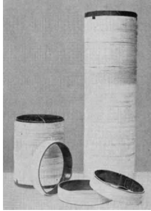
Bild 1. Spulen von 207 mm \varnothing mit verschiedenen Windungszahlen und Einzelspulen.
