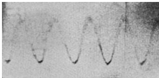
Bild 9. Ungedämpfte Schwingung 1,0 \cdot 10^6 Hertz. Anodenspannung: 1000 Volt. Spannungsmaßstab: 0,1 cm/Volt.
