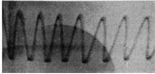
Bild 7. Ungedämpfte Schwingung 1,4 \cdot 10^6 Hertz. Anodenspannung: 1000 Volt. Spannungsmaßstab: 0,1 cm/Volt.
