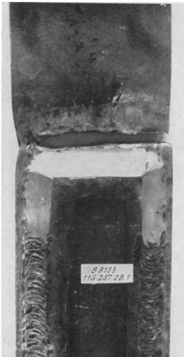
Abb. 39. Probekörper 2 B. 1 der Reihe K. Bruch nach 715 100 Lastspielen zwischen \sigma_{uz} = 0,5 \text{ kg/mm}^2 und \sigma_{oz} = 18,5 \text{ kg/mm}^2 .
