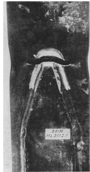
Abb. 34. Probekörper I. 1. der Reihe F. Bruch nach 392 800 Lastspielen zwischen \sigma_{uz} = 0,5 \text{ kg/mm}^2 und \sigma_{oz} = 18,5 \text{ kg/mm}^2 .
