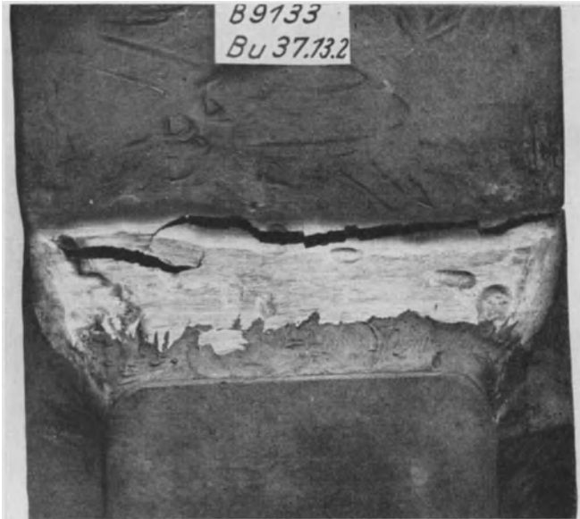
Abb. 50. Probekörper Bu 37. 13. 2 der Gruppe VI. Bruch nach 334 300 Lastspielen zwischen \sigma_{ubz} = 1,0 \text{ kg/mm}^2 und \sigma_{obz} = 20,0 \text{ kg/mm}^2 .
