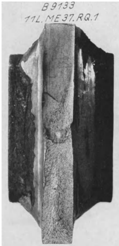
Abb. 48. Bruchfläche des Probekörpers R.Q. 1 der Reihe R, vgl. Abb. 47.
