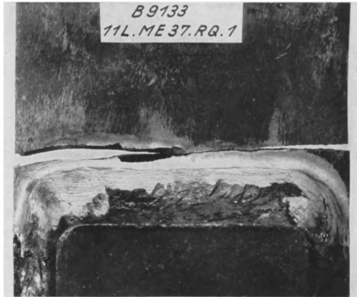
Abb. 47. Probekörper R.Q. 1 der Reihe R. Bruch nach 375 800 Lastspielen zwischen \sigma_{uz} = 0,6 \text{ kg/mm}^2 und \sigma_{oz} = 17,5 \text{ kg/mm}^2 .
