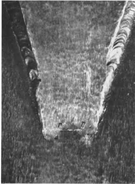
Abb. 31. Risse am Laschenende eines Probekörpers der Reihe B vor dem Dauerversuch.
