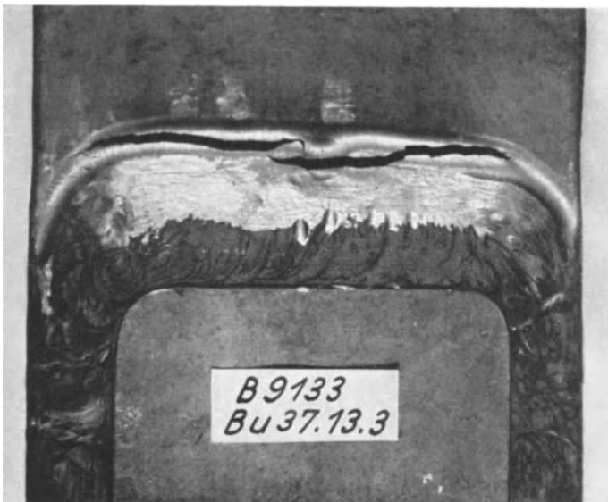
Abb. 51. Probekörper Bu 37. 13. 3 der Gruppe VI. Bruch nach 594 700 Lastspielen zwischen \sigma_{ubz} = 1,1 \text{ kg/mm}^2 und \sigma_{obz} = 17,1 \text{ kg/mm}^2 .
