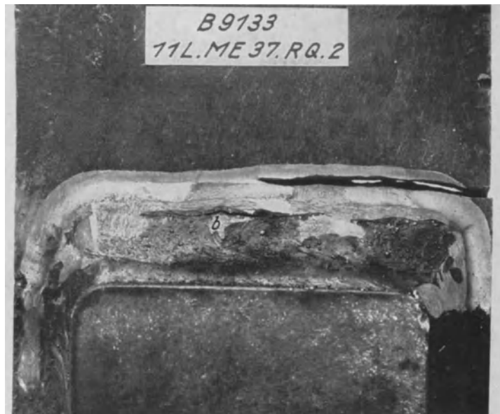
Abb. 49. Probekörper R.Q. 2 der Reihe R. Bruch nach 925 500 Lastspielen zwischen \sigma_{uz} = 0,5 \text{ kg/mm}^2 und \sigma_{oz} = 17,5 \text{ kg/mm}^2 ; in der nicht bearbeiteten Schweißnaht war der Riß b entstanden.
