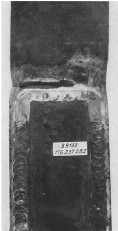
Abb. 41. Probekörper 2 B.2 der Reihe L. Bruch nach 775 000 Lastspielen zwischen \sigma_{uz} = 0,5 \text{ kg/mm}^2 und \sigma_{oz} = 18,5 \text{ kg/mm}^2 .
