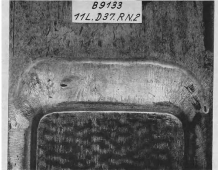
Abb. 44. Probekörper RN. 2 der Reihe N nach 1031 100 Lastspielen zwischen \sigma_{uz} = 0,5 \text{ kg/mm}^2 und \sigma_{oz} = 17,5 \text{ kg/mm}^2 .
