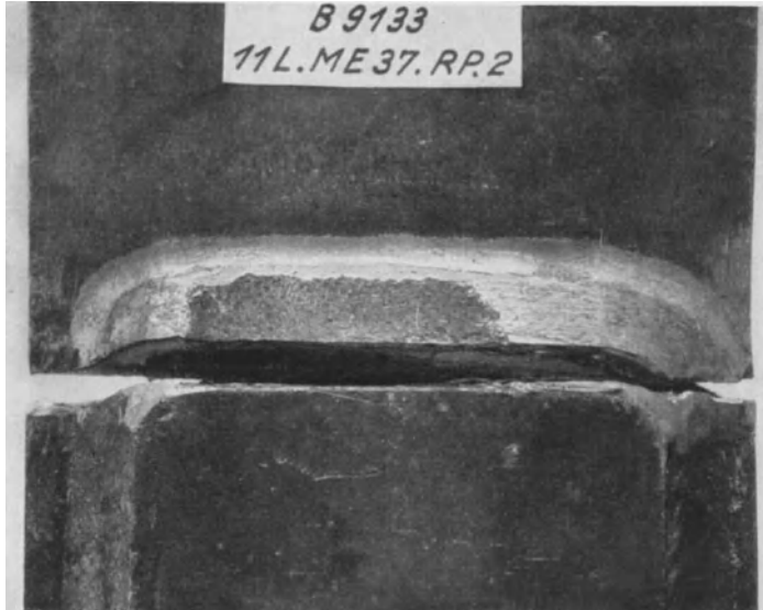
Abb. 45. Probekörper RP. 2 der Reihe Q. Bruch nach 1 067 800 Lastspielen zwischen \sigma_{uz} = 0,6 \text{ kg/mm}^2 und \sigma_{oz} = 17,5 \text{ kg/mm}^2 .
