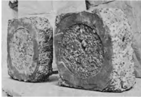
Abb. 6. Aus dem Bauwerk ausgespitzter Beton, für die Prüfung auf Wasserdurchlässigkeit hergerichtet.
