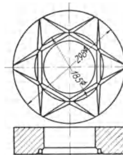
Abb. 1124. Druckring eines Schiffsturbinenlagers Nach Lasche. M. 1:10.
