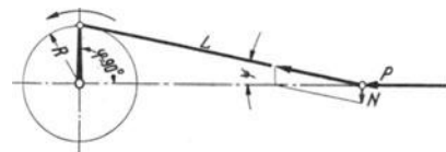
Abb. 1178. Zerlegung des Kolbendruckes P im Kreuzkopf.
