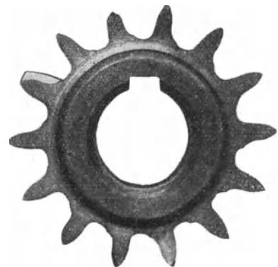
Abb. 1878. Abnutzung der Flanken an einem Rade mit Evolventenverzahnung.
