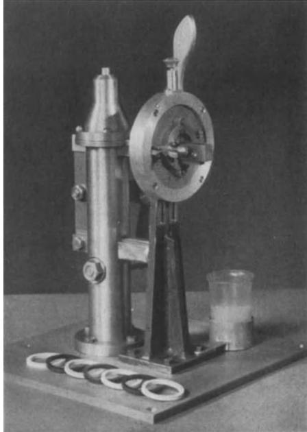
Abb. 10. Schneidegerät zur Kerbzähigkeitsprüfung.
