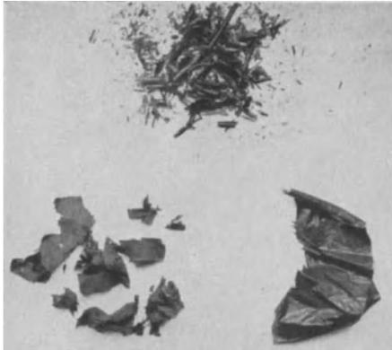
Abb. 12. Zur Kugel zusammengefaltete Späne. Oben kittartig und ganz zerfallen (Bewertung 4), unten links etwas zerfallen (Bewertung 3), unten rechts geknickt und zerknittert, aber zusammenhängend (Bewertung 1). (Nach Peters.)
