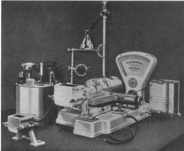
Abb. 3. Versuchsanordnung für die plastographische Messung mit dem Plastographen v. Brabender.
