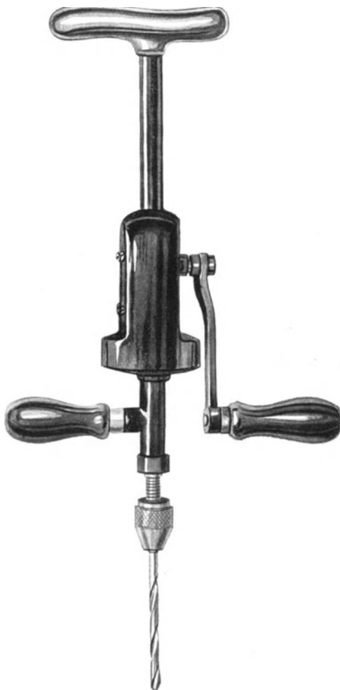
Abb. 533. Handbohrmaschine mit Kugellagern und Gewindebohrer.
