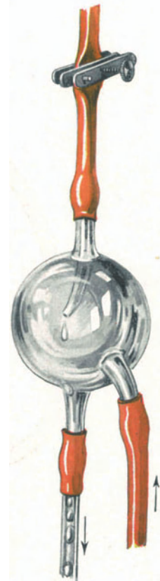
Abb. 225. Die in den Tropfsauger eingeschaltete Tropfkugel mit Seitenanschluß und vorgeschaltetem Quetschhahn.
