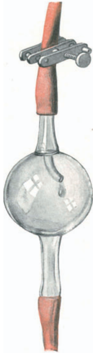
Abb. 314. MARTINSche Tropfkugel gestattet die Beobachtung der Tropfenfolge, deren Schnelligkeit durch den oberhalb angebrachten Quetschhahn eingestellt wird.
