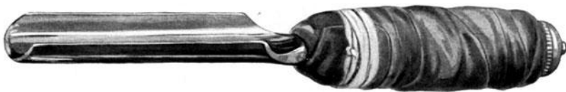
Abb. 541. Hohlmeißel, dessen Griff zum sicheren Festhalten mit einer Gummibinde umwickelt ist.
