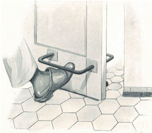
Abb. 222. Vorrichtung zum Öffnen der Türen mit dem Fuß, so daß die Sterilität steril eingekleideter Personen nicht verletzt wird.
