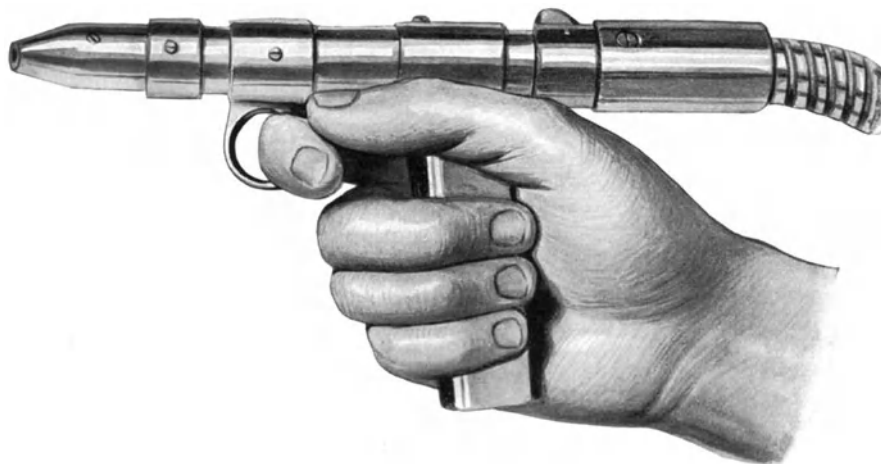
Abb. 535. Handstück der elektrisch angetriebenen Bohrmaschine mit Hahn zum An- und Abstellen.
