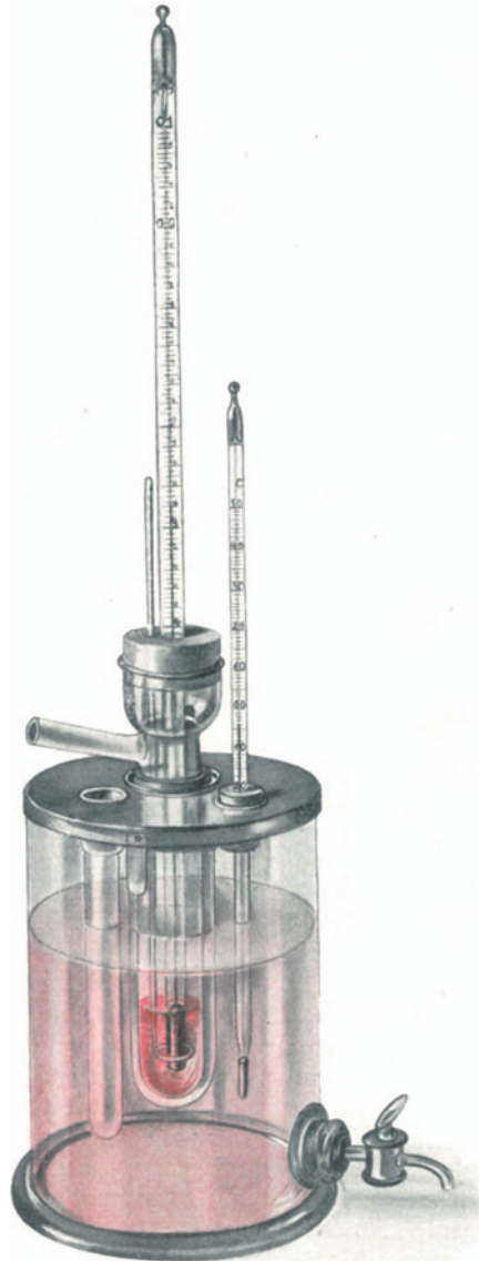
Abb. 2. BECKMANNscher Apparat zur Kryoskopie. Der Temperaturunterschied zwischen dem Gefrierpunkte von destilliertem Wasser und dem Gefrierpunkte der zu untersuchenden Flüssigkeit (in unserem Falle des defibrinierten Blutes) ist die Gefrierpunktserniedrigung ( \delta ) der zu untersuchenden Flüssigkeit, deren Größe der Menge der gelösten Salze direkt proportional ist.
