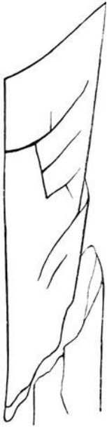
Abb. 7. Neben der durch Schubkräfte entstandenen Bruchlinie sind mehrere Parallelschäden, auch im rechten Winkel dazu zu erkennen (aus HAASE).
