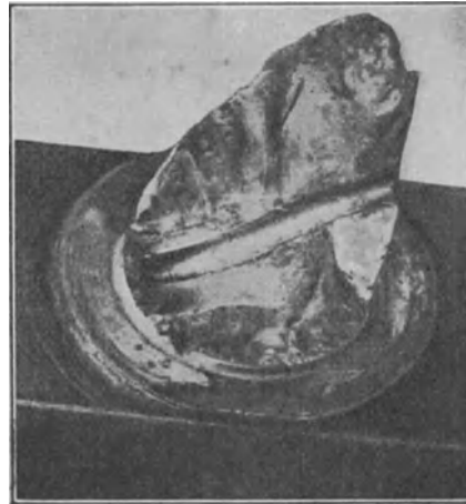
Abb. 505 und 506. Falsch gebohrte Kurbelwelle.
