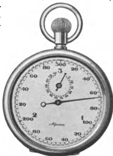
Abb. 121. Alpina-Stoppuhr mit Ablesungsmöglichkeit bis 0,01 sec.
