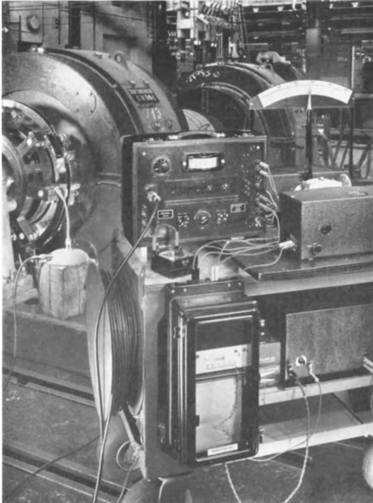
Abb. 11. Schalldruckmesser in Benutzung. Kondensatormikrophon links in der Nähe der Maschine stehend, Schalldruckmesser mit Anzeigegerät auf dem Tisch links, rechts Gerät zur Suchtonanalyse mit Schwebungssumme, vorn Tintenschreiber zur Aufzeichnung des Schallspektrums.
