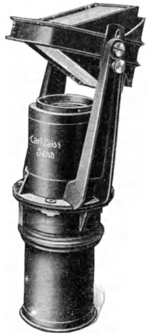
Abb. 48. Montierung eines Objektivprismas.
