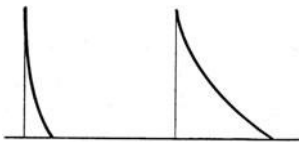
Abb. 34. Entladung eines kleinen und eines größeren Kondensators.
