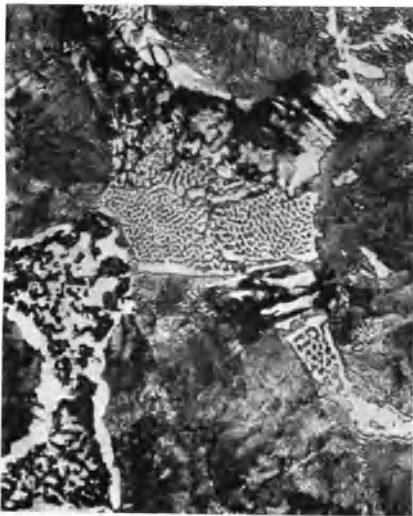
Abb. 53. Gußeisen im Erstarrungsintervall von 1120° in Wasser abgeschreckt. (Ätzung II, \times 500 .)
