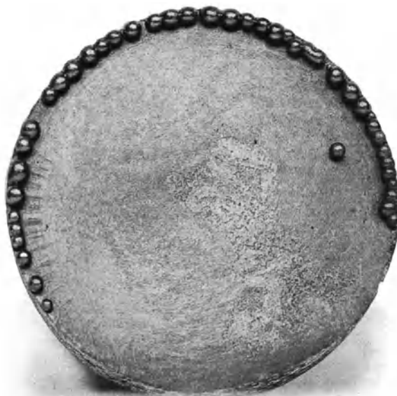
Abb. 144. Schwitzkugeln an der Oberfläche einer phosphorhaltigen Laboratoriums-Gußeisenschmelze. \times 2 .
