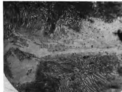
Abb. 25. Punktförmige Ausscheidung von elementarem Kohlenstoff an einer harten Stelle von Grauguß Ätzung II \times 250.
