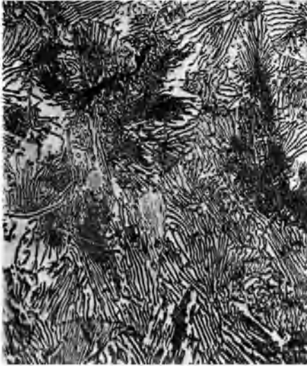
a) ohne Nickel. Lam. Perlit. \times 500 .
