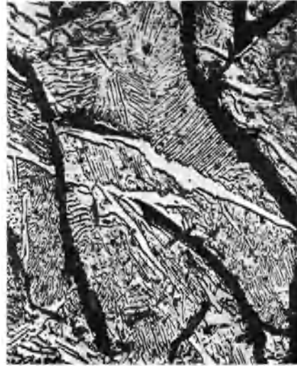
Abb. 52. Gußeisen mit labiler Zusammensetzung, langsam erkaltet. (Ätzung II, \times 500 .)
