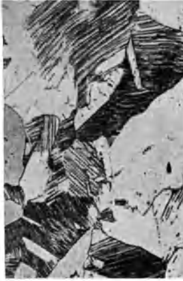
Abb. 156. Homogener Austenit. Ätzung II \times 500.
