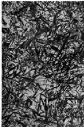
Abb. 155. Austenit und Martensit. Ätzung II \times 500.
