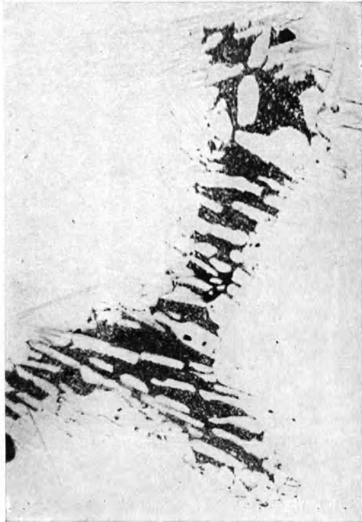
Abb. 108. Ternäres Phosphideutektikum, geätzt mit neutralem Natriumpikrat. \times 500 .
