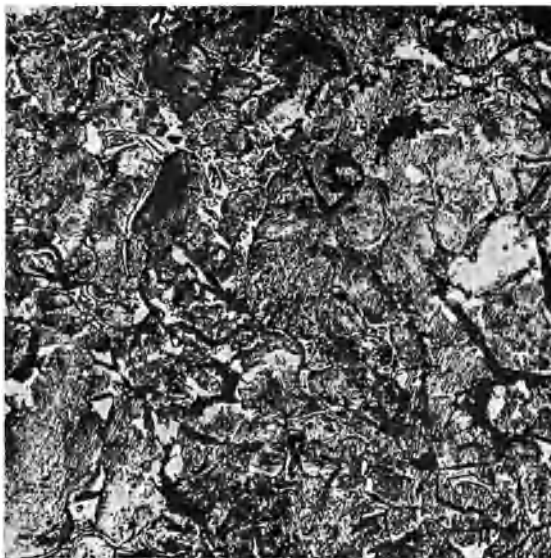
Abb. 254. Wie Abb. 253 jedoch vor dem Abgießen in der Scherpfanne 2,5% Blei zugesetzt. Pikrinsäureätzung \times 200 .
