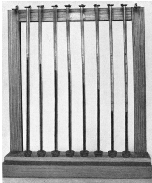
Abb. 49. Apparat zur Beobachtung der Blutkörperchensenkung nach WESTERGREN-KATZ 1) . Von links: 1. gesund, 6 mm. 2. prod. Tub., Stad. I, 13 mm. 3. prod. Tub., offen, Stad. I, 18 mm. 4. desgl., Stad. II, 25 mm. 5. prod. Tub. mit Kavernen, 35 mm. 6. desgl. schwer, 56 mm. 7. desgl. mit leichtem Fieber, 87 mm. 8. fieberhafte exsudative Phthise, 109 mm.
