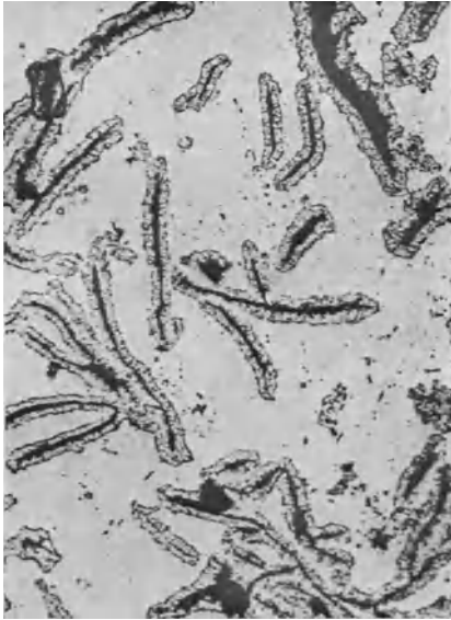
Abb. 741. Gefügeänderung von Gußeisen nach 30 mäßiger Pendelung zwischen 600° und 950° C (ungeätzt, V = 250 ). Nach E. PIWOWARSKY und W. FREYTAG.
