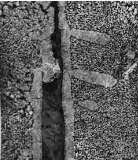
Abb. 136. Übereutektisches Gußeisen, schwach geätzt. V = 200 (H. NIPPER).
