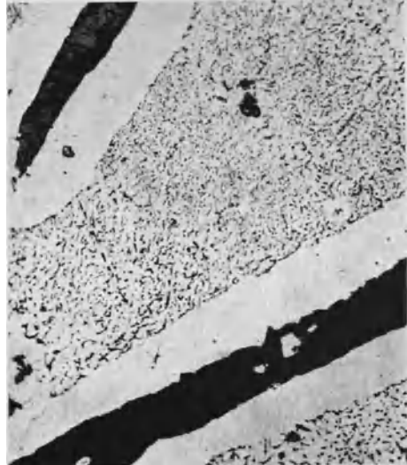
Abb. 135. Übereutektisches Gußeisen, geätzt. V = 200 (H. NIPPER).
