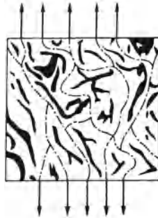
Abb. 300. Spannungsverlauf in Gußeisen.
