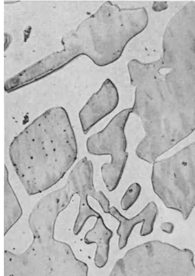
Abb. 942. Gußeisen mit etwa 2,6% C und etwa 18,5% Al; geätzt, Gußzustand. \times 500 .
