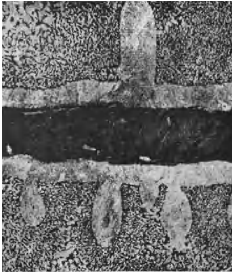
Abb. 138. Übereutektisches Gußeisen, schwach geätzt. V = 200 (H. NIPPER).
