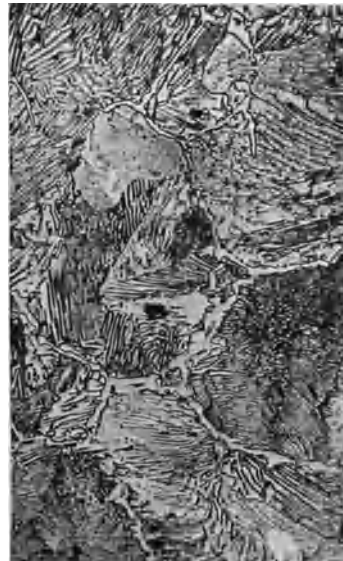
Abb. 30. Eisen mit 1,23% C. Geätzt. V = 500.
