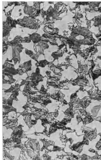
Abb. 28. Eisen mit 0,6% C. Geätzt. V = 200.
