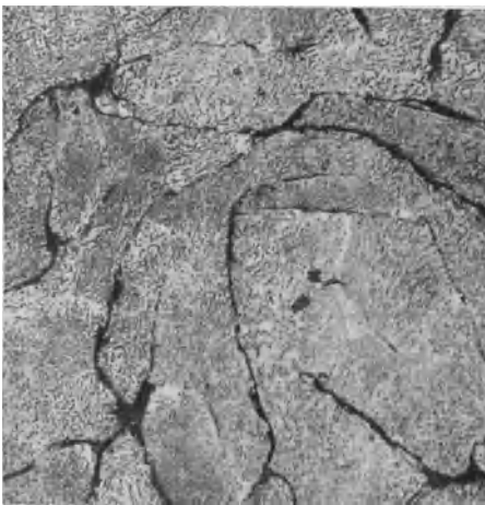
Abb. 983. Zu kurz poliert, der Graphit ist noch zugegratet und der Perlit unnatürlich körnig.
