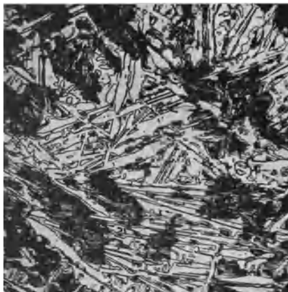
Abb. 105. Gefüge von Kell Nr. 3. V = 500 . 3 mm von der Kellspitze entfernt.
