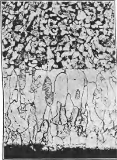
Abb. 387. Probe mit 0,32% C. Strömender Wasserstoff von 20 \text{ kg/cm}^2 , 700^{\circ} , 3 std.
