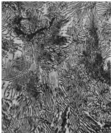
Abb. 884. Ohne Nickel. Lam. Perlit. \times 500 .
