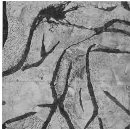
Abb. 984. Richtig poliert, der Graphit ist scharf begrenzt und glatt, der Perlit streifig.
