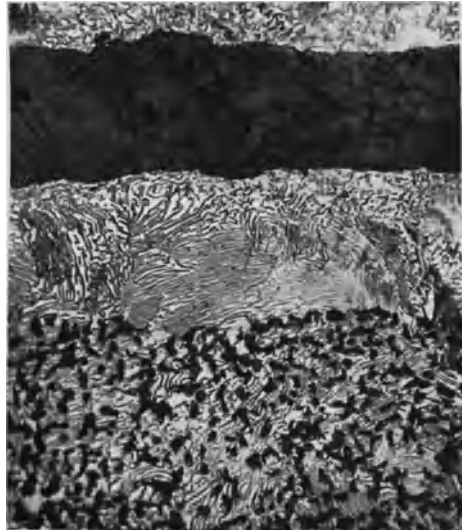
Abb. 137. Übereutektisches Gußeisen, geätzt. V = 500 (H. NIPPER).
