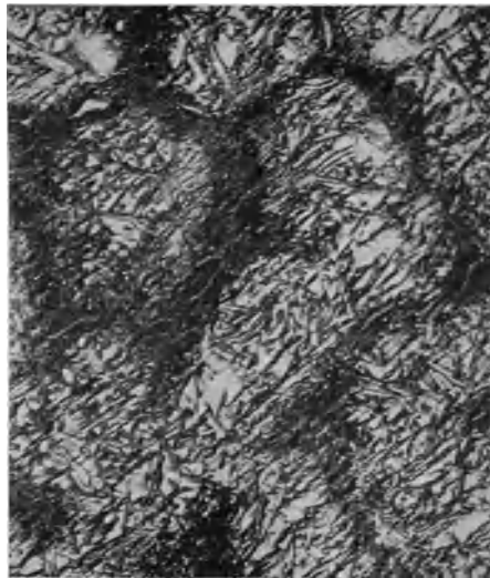
Abb. 887. Mit 8 % Ni. Martensit. \times 500 .
