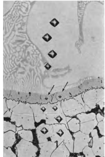
Abb. 572. Hartlötung von Stahl mit Cu-P-Lot (Querschliff). Prüflast 10 g. V = 500 (H. HANEMANN).
