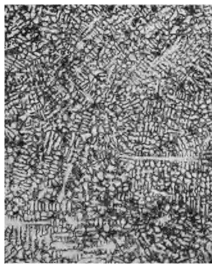
Abb. 280. Primärgefüge der Tiegelofenschmelze T_{00} (mit Ferro-Titan behandelt). V = 20
