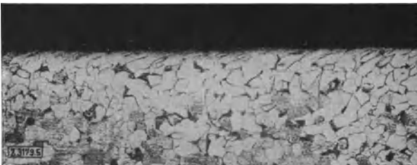
Abb. 505. Oberfläche nach Versuchen in Kohlendioxyd.
