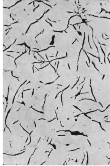
Abb. 35. Grauguß mit ziemlich guter Graphitbildung. Ungeätzt. V = 100 .
