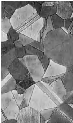
Abb. 837. Homogener Austenit mit ausgeprägter Zwillingsbildung. V = 500.
