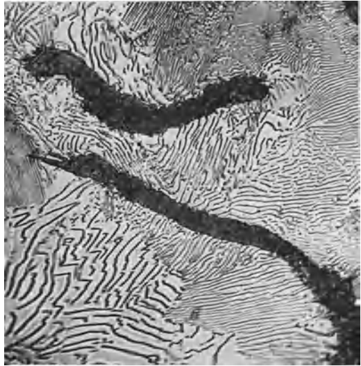
Abb. 517. Grauguß mit lamellar perlitischem Gefüge. V = 500 .
