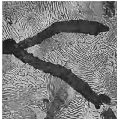
Abb. 988, richtig poliert, aber zu lange geätzt
