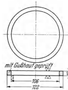
Abb. 647. Abmessungen der aus der Büchse ausgearbeiteten Ringe.
