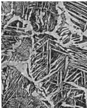
Abb. 827 und 828. Stahlguß mit etwa 0,35% C. V = 50 .
