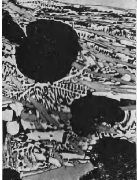
Abb. 329. Thomasroheisen nach Sonderätzung II (nach M. KÜNKELE). V = 1000 . Zementit = getönt, Eisenphosphid = hell, Mischkristalle = dunkel.
