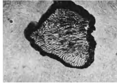
Abb. 838. Perlitkristall, bei 680° gebildet und in seinem Wachsen durch Abschrecken unterbrochen. V = 1000 . (E. SCHEIL u. Mitarbeiter).
