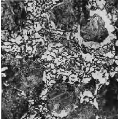
Abb. 100. Eutektikum mit viel Ferrit. V = 500 .
