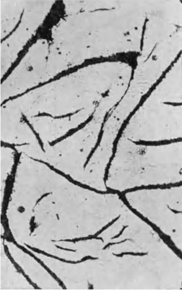
Abb. 34. Grauguß mit sehr grober und ungünstiger Graphitbildung. Ungeätzt. V = 100 .
