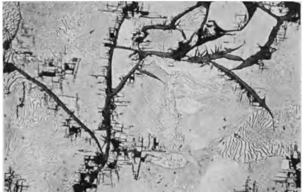
Abb. 82. Segregatgraphit in Widmannstättenscher Anordnung (H. HANEMANN). V = 600 .
