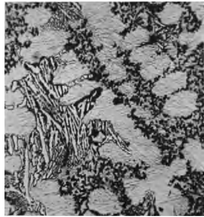
Abb. 231a. Gefüge der Zone I nach Abschreckung. V = 1000 .
