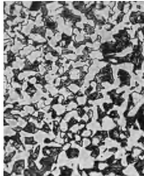
Abb. 827 und 828. Stahlguß mit etwa 0,35% C. V = 50 .
