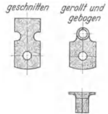
Abb. 70. Werkstück, das in den Arbeitsstufen der Abb. 71 mit dem Werkzeug Abb. 72 gefertigt wird.
