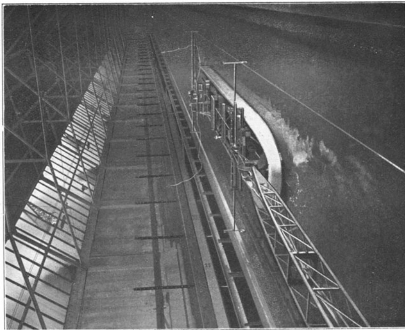
Fig. 70. Doppelschraubenschiffe in Fahrt. Schrauben über oben nach außen schlagend. Fahrgeschwindigkeit 0,44 m/sk (5,0 km/st).
