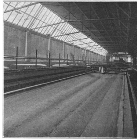
Fig. 47. Einwirkung der Schrauben auf die Sohle des Modells des Großschiffahrtsweges Berlin-Stettin nach 1780 Fahrten. Fahrtgeschw. v = 0,320 bis 0,437 m/sk (3,65 bis 4,95 km/st).
