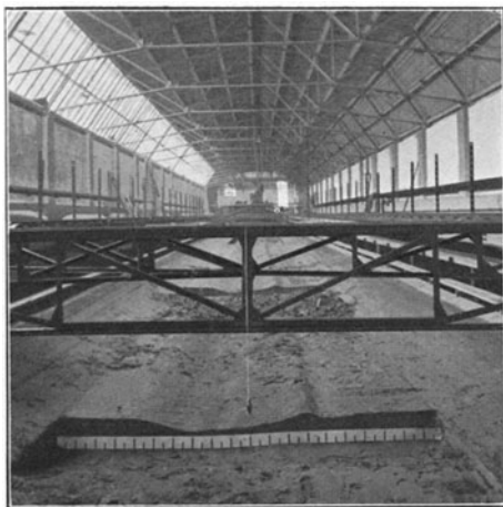
Fig. 58. Dasselbe wie Fig. 57. Kies von 1,25 bis 1,75 mm Korngröße, Bedeckungstiefe 15 mm.
