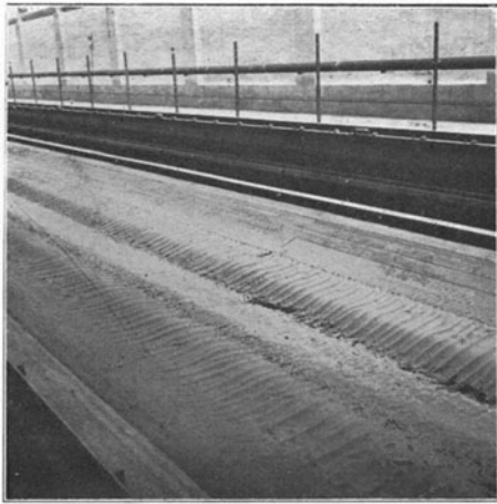
Fig. 42. Einwirkung der Schrauben auf das Modell des ursprünglich vorgesehenen Profils des Rhein-Weser-Kanals nach 3400 Fahrten.
