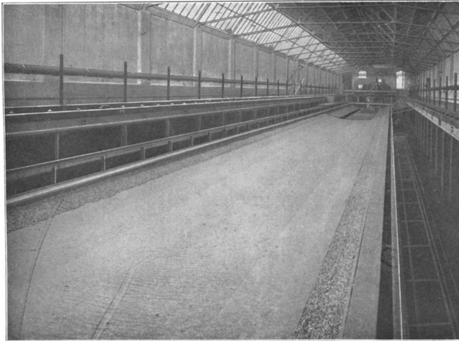
Fig. 82. Einwirkung der Einschraubenschiffe mit Heckabdeckung und 2 Rudern auf die Sohle des Modells des Rhein-Weser-Kanals nach 4000 Fahrten.
