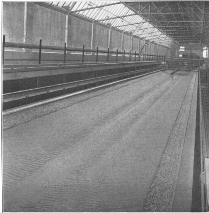
Fig. 78. Einwirkung der Einschraubenschiffe mit Heckabdeckung und 1 Ruder auf die Sohle des Modells des Rhein-Weser-Kanals nach 4000 Fahrten.
