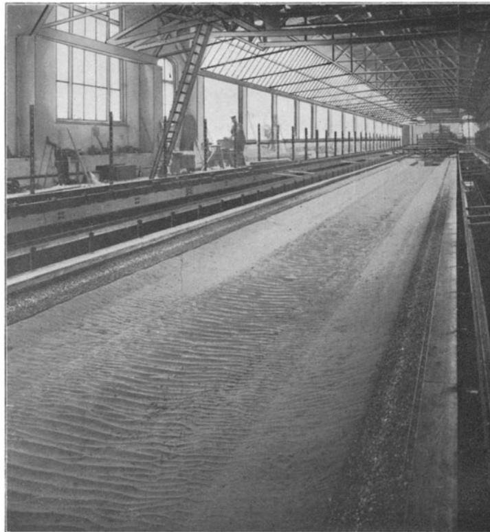
Fig. 73. Einwirkung der Doppelschraubenschiffe auf die Sohle des Modells des Rhein-Weser-Kanals nach 4000 Fahrten. Schrauben über oben nach außen schlagend.
