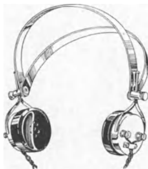
Abb. 22. Bügelanordnung, Einstellvorrichtung und Halteeinrichtung sowie Herausführung der Zuleitungen bei einem Doppelkopftelephon von I. G. Brown, Ltd., London. Das Doppelkopftelephon ist ganz besonders leicht ausgeführt.
