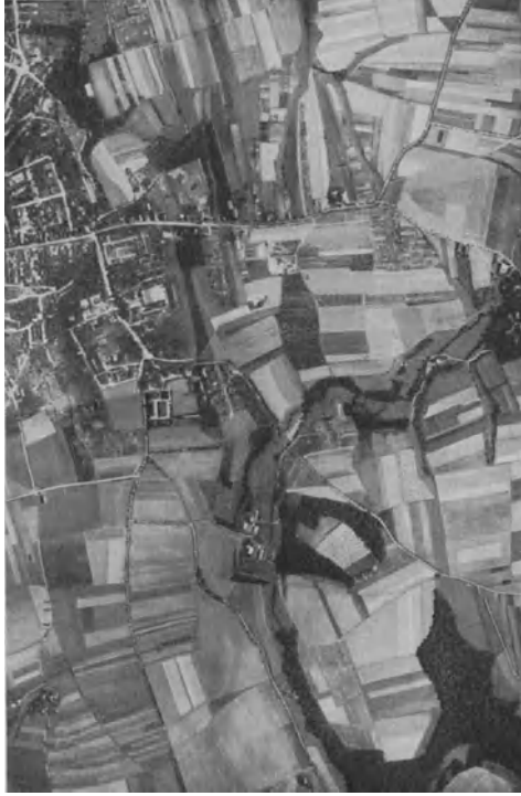
Abb. 268. Luftbildskizze (S. 217), hergestellt nach Aufnahmen aus einem JUNKERS W. 33 für die AEROKARTOGRAPHISCHES INSTITUT A.-G., Breslau. Man beachte die Wegversetzung z. B. in der SW-Ecke, hervorgerufen durch Höhenunterschiede und Neigung der Einzelaufnahmen
