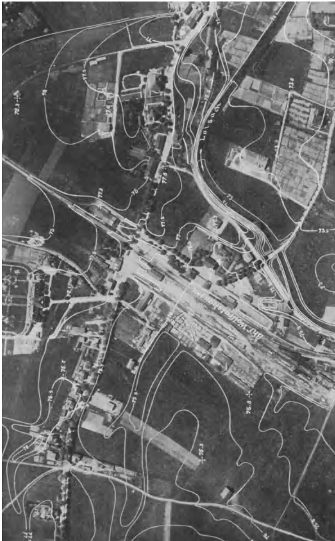
Abb. 29. Luftbildplan mit terrestrisch eingemessenen Schichtlinien (Photogrammetrie G. m. b. H. in München)
