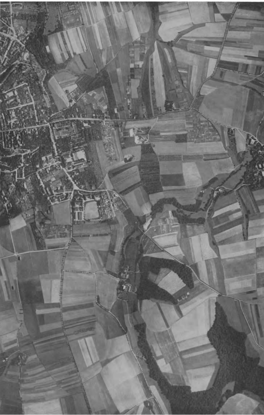
Abb. 269. Luftbildplan (S. 217), hergestellt nach den in Abb. 268 wiedergegebenen Aufnahmen mit Entzerrungsgerät Abb. 24, S. 21, durch die AEROKARTOGRAPHISCHES INSTITUT A.-G., Breslau
