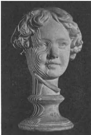
Abb. 35. Aufnahme eines Kleinkörpers mit den Spuren paralleler Lichtebenen nach K. ZAAR
