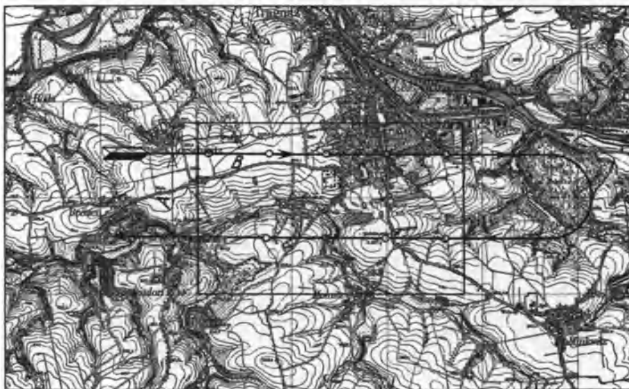
Abb. 251. Entwurf des Flugplanes in einer Übersichtskarte. H = 1800 m, A = 880 m, B = 660 m (vgl. Abb. 245)
