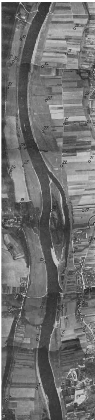
Abb. 233. Beispiel einer Aerotriangulation nach dem Normalreihen-Verfahren (Elbestrecke Dresden-Meißen)
