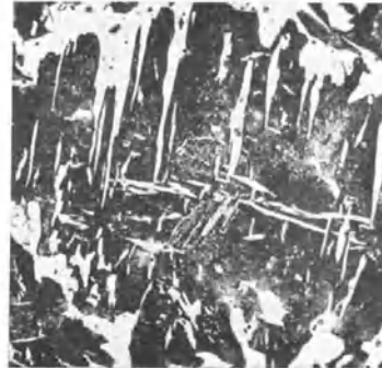
Abb. 568. Gußgefüge von Stahlguß mit 0,27% C. Vergr. 50. Abb. 569. Gußgefüge von Stahlguß mit 0,42% C. Vergr. 50.
