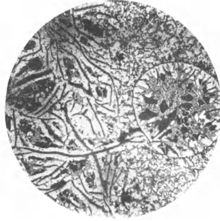
Abb. 659. Eisenkügelchen in der Schweiße. Vergr. 25.
