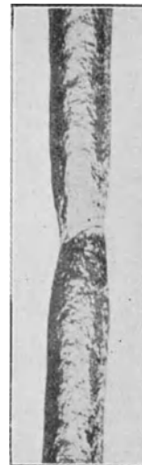
Abb. 620. Probestab mit 0,11% C, bei zu niedriger Temperatur (800°) geglüht.
