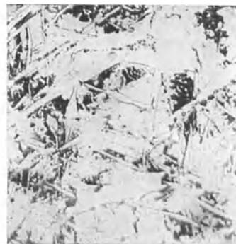
Abb. 585. Stahlguß mit 0,27% C, bei 800° geglüht. Vergr. 80.
