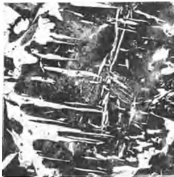
Abb. 590. Stahlguß mit 0,4\% C, ungeglöh­. Vergr. 100.
