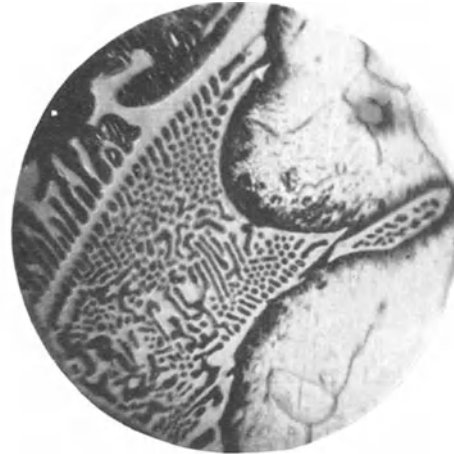
Abb. 657. Zersetztes Eisenphosphid-Eutektikum. Vergr. 750.
