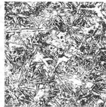
Abb. 591. Stahlguß mit 0,4\% C, bei 730^{\circ} geg­löh­. Vergr. 100.
