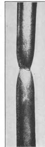
Abb. 621. Probestab mit 0,11% C, bei richtiger Temperatur (890°) geglüht.
