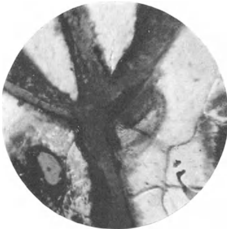
Abb. 656. Oxydiertes Gußeisen. Vergr. 750.
