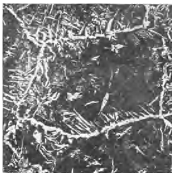
Abb. 575. Desgleichen. Ferrit III. Vergr. 50.
