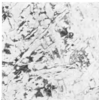
Abb. 584. Stahlguß mit 0,27% C, bei 750° geglüht. Vergr. 80.
