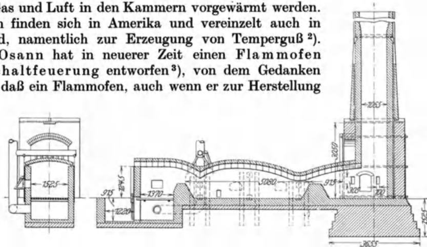
Abb. 216. Amerikanischer Gießereiflammofen mit Unterwind.
