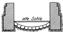
Abb. 59. Vertiefung einer Brückensohle.
