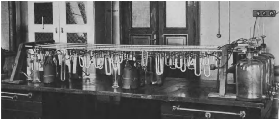
Abb. 10. Laboratoriumsapparat zur Messung der Bodenatmung.
