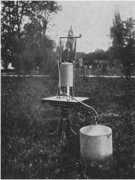
Abb. 9. Der Glockenapparat von LUNDEGÅRDH mit der Bodenglocke zur Messung der Bodenatmung. (Biochem. Z. 193, 352, Fig. 1.)
