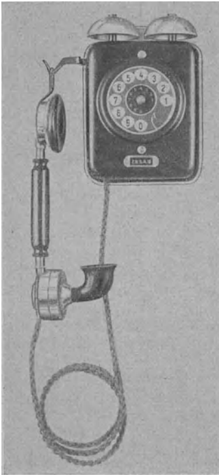
Abb. 4. Station mit Selbstwähler und deren Schutzkappe.
