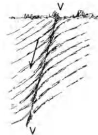
Schichtenschleppung längs des Verwerfers VV .
