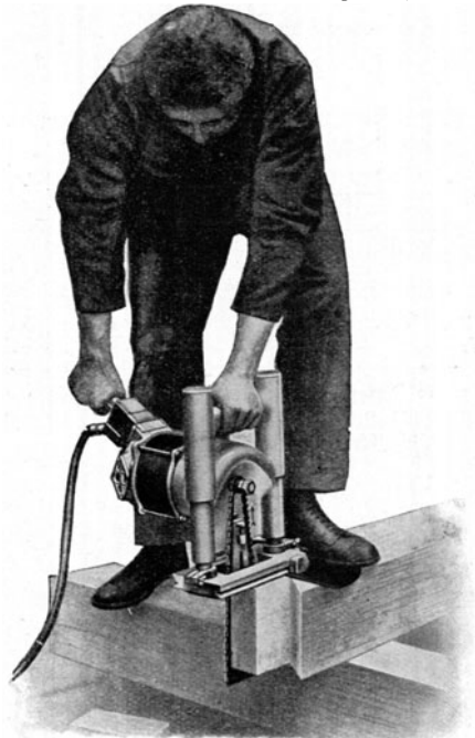
Abb. 58. Handmaschine wie Abb. 55; Fräskette mit unten horizontaler Führung (dreieckige Führungsleiste).
