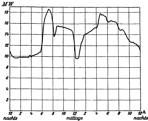
Fig. 429. Belastungskurve eines Wintertages für die Zentrale der Oberschlesischen Elektrizitäts-Werke.
