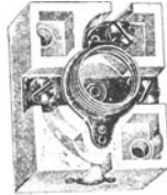
Fig. 485 und 486. Normalelement für Edison-Sicherungen (AEG).
