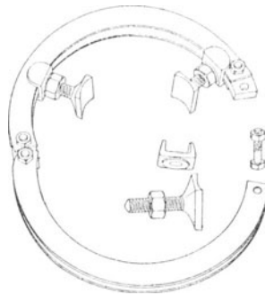
Fig. 448. Gußeiserner Ring mit verstellbaren Stützen für Verteilungspunkte.
