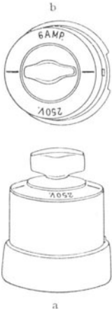
Fig. 479 a, b. Normaler Drehschalter (AEG).
