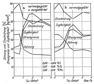
Abb. 82 a und b. Festigkeitseigenschaften von normalgeglühten und ausgehärteten Eisen-Kupfer-Legierungen (Williams und Lorig).
