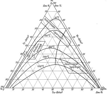
Abb. 109. Grenzen der Mischungslücke (Köster und Dannöhl) und magnetisch wichtige Legierungen (Bumm und Müller) im System Eisen-Nickel-Kupfer.
