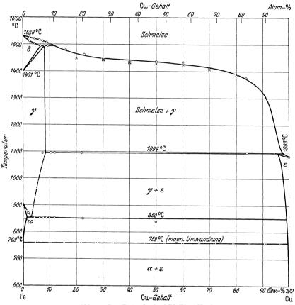
Abb. 1. Das Zustandsschaubild Eisen-Kupfer. (× Nach Iwasé und Mitarbeitern.) (o Nach Iron Steel Inst. 1936. Special Report Nr. 14, S. 100.)
