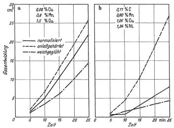
Abb. 98 a und b. Lösungsgeschwindigkeit kupferlegierter Stähle in 1 n-Salpetersäure (Probenoberfläche  $13,5~{\rm cm^2}$ ) (Rädeker).
