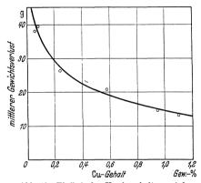
Abb. 49. Einfluß des Kupfergehaltes auf den Gewichtsverlust von Blechen in heißen Abgasen (Storey).
