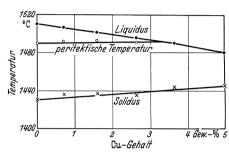
Abb. 8. Schnitt durch das flüssige System Fe-Cu-C bei 0,4 % C (Andrew, Bottomley, Maddocks, Percival).
