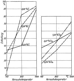
Abb. 72. Entkohlung von Kohlenstoff- und Kupferstählen durch Wasserstoff (Baukloh und Guthmann).
