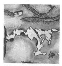
Abb. 159. Gefüge von Niresist. V = 200.
