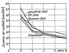
Abb. 54. Abhängigkeit des Lochfraßes von der Zeit in 22 Böden (Logan und Grodsky).
