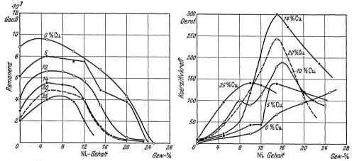
Abb. 117. Remanenz und Koerzitivkraft von angelassenen Eisen-Nickel- und Eisen-Kupfer-Nickel-Legierungen in Abhängigkeit vom Nickelgehalt (Legat).
