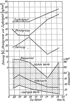
Abb. 43. Festigkeitswerte widerstandsgeschweißter Proben (Zeyen und Mehl).
