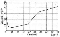
Abb. 62. Korrosion von Eisen-Kupfer-Legierungen Schwefelsäure 1:3 (Clavenger und Ray).
