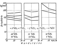
Abb. 164. Abhängigkeit der Härte von Niresist mit 2,6% C von der Wandstärke bei verschiedenen Nickel-, Kupfer- und Chrom-Gehalten (Roll).
