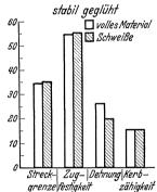
Abb. 45. Mittlere Festigkeitswerte von Blech und Schweiße aus Kupfer-Nickel-Stahl (Nehl).
