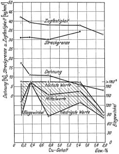
Abb. 41. Festigkeitswerte autogen geschweißter Proben (Zeyen und Mehl).
