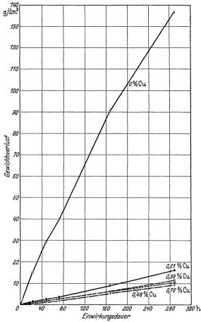
Abb. 58. Gewichtsabnahme von Stahlproben mit 0,1% P und 0,1% S in  $\frac{n}{5}$ -Salzsäure (Bardenheuer und Thanheiser).
