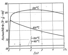
Abb. 89. Anlaßisothermen der Härte einer von 850° abgeschreckten 50 Fe-50 Cu-Legierung (Schuhmacher und Souden).
