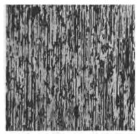
Abb. 140. Kaltgezogener Draht aus einer Legierung mit 50% Cu und 50% Fe. Längsschnitt. Geätzt mit NH<sub>4</sub>OH—H<sub>2</sub>O<sub>2</sub>. V = 125 (Schuhmacher und Souden)
