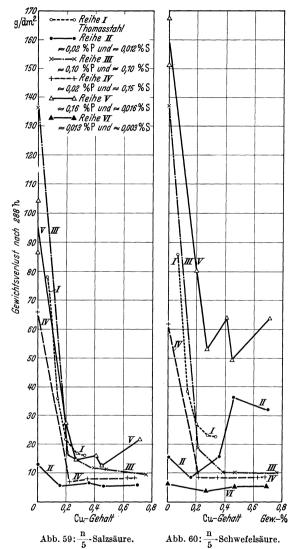
Abb. 59 und 60. Gewichtsabnahme in 288 Stunden von Stählen verschiedener Reinheit in Abhängigkeit vom Kupfergehalt (Bardenheuer und Thanheiser).
