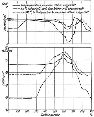
Abb. 77. Einfluß des Glühens auf Koerzitivkraft und Leitfähigkeit einer 5 % igen Eisen-Kupferlegierung mit 0,04 % C nach verschiedener Vorbehandlung (Buchholtz und Köster).
