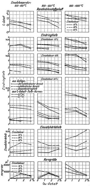
Abb. 40. Einfluß des Kupfers auf die Zementationswirkung (Houdremont und Schrader).
