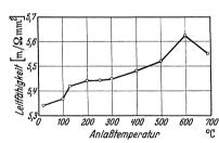
Abb. 86. Änderung der elektrischen Leitfähigkeit beim Anlassen eines an Kohlenstoff und Kupfer übersättigten Stahls mit 0,05% C (Buchholtz und Köster).
