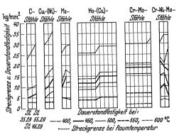
Abb. 129. Rohrwerkstoffe für den Dampfkesselbau (Gewährwerte) (Houdremont).
