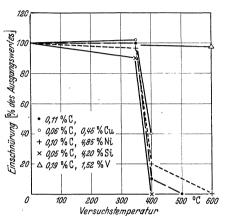
Abb. 73. Einfluß von Kupfer, Nickel, Silizium und Vanadin auf die Einschnürung von Stahl nach Wasserstoffglühung (100Stunden, 300 kg/cm² H<sub>2</sub>) (Naumann).
