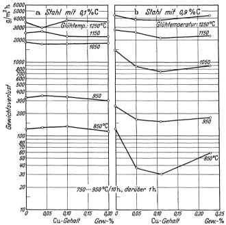
Abb. 66. Gewichtsverlust durch Zunderung in oxydierender Atmosphäre (Bennek).
