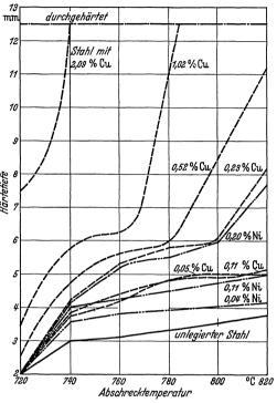
Abb. 36. Erhöhung der Härtetiefe von Stählen mit rund 0,9% C durch Kupfer und Nickel (Bennek).
