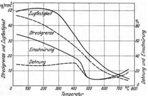
Abb. 139. Ergebnisse von Zerreißversuchen kurzer Dauer in der Wärme an einer geschmiedeten Legierung mit 50% Cu und 50% Fe (Simpson und Banister).
