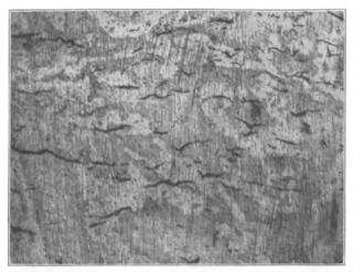
Abb. 70. Oberfläche eines Hohlkörpers mit Rissen (rund ×2) (Nehl).
