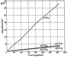
Abb. 57. Gewichtsabnahme von Stahlproben mit  $0.02\,\%$  P und  $0.15\,\%$  S in  $\frac{1}{5}$ -Salzsäure (Bardenheuer und Thanheiser).
