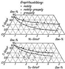
Abb. 144. Einfluß von Kupfer und Nickel auf die Graphitausbildung in untereutektischen Eisen-Kohlenstoff-Legierungen (von Keil und Ebert).
