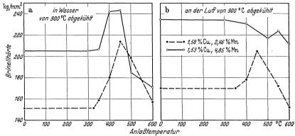
Abb. 91 a und b. Einfluß der Abschreckgeschwindigkeit auf die Ausscheidungshärtung bei Kupfer-Mangan-Stahl (Eilender, Fry und Gottwald).
