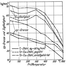
Abb. 130. 0,2-Grenze und Zugfestigkeit von Kohlenstoff- und Chrom-Kupfer-Stahl in Abhängigkeit von der Prüftemperatur (Buchholtz und Köster).
