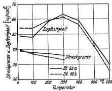
Abb. 44. Streckgrenze und Zugfestigkeit stumpfgeschweißter Proben aus Mangan-Chrom-Kupfer-Stahl (St 52a und b nach Zahlentafel 20) in Abhängigkeit von der Temperatur (Lohmann und Schulz).
