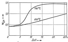
Abb. 112. Änderung der Koerzitivkraft einer von 1000°abgeschreckten Eisen-Nickel-Kupfer-Legierung mit 13,1% Cu beim Anlassen (Bumm und Müller).
