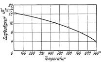
Abb. 163. Warmfestigkeit von Niresist-Gußeisen (Kurzzerreißversuche: Ballay).
