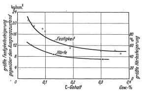
Abb. 80. Einfluß des Kohlenstoffgehaltes auf die größte Festigkeitssteigerung (Nehl) und die größte Härtesteigerung (Eilender, Fry, Gottwald) beim Anlassen von Kupferstählen.
