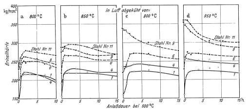
Abb. 103 a bis d. Einfluß der Normalisierungstemperatur und der Anlaßdauer bei 500° auf die Härte von Chrom-Kupfer-Stählen (Harrison).
