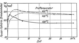
Abb. 105. Pendel-Fallhärte einer von 850° abgeschreckten Eisen-Kupfer-Legierung mit 1,5% Cu bei 400, 450 und 500° in Abhängigkeit von der Glühdauer (Cornellus und Trossen).
