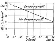
Abb. 160. Garschaum-Graphit-Bildung in Abhängigkeit vom (Kupfer+Nickel)-Gehalt und vom Kohlenstoffgehalt des Gußeisens (Roll).
