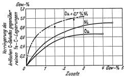
Abb. 145. Graphitfördernde Wirkung von Kupfer und Nickel (von Keil und Ebert).
