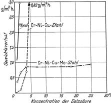
Abb. 64. Wie Abb. 63, aber wechselnder Angriff von Salzsäure und Luft bei Raumtemperatur (Houdremont).
