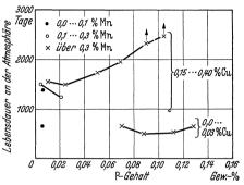
Abb. 51. Lebensdauer ungekupferter und gekupferter Stahlbleche an der Atmosphäre in Abhängigkeit vom Phosphor- (und Mangan-) Gehalt (Kendall und Speller).
