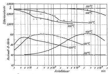
Abb. 107. Änderung der Härte und des Gitterparameters einer Legierung mit 2% Cu mit der Anlaßdauer bei verschiedenen Temperaturen (Norton).
