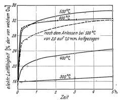
Abb. 88. Anlaßisothermen der elektrischen Leitfähigkeit einer von 850° abgeschreckten 50 Cu-50 Fe-Legierung (Schuhmacher und Souden).
