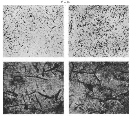
V=280 Abb. 143. Graphitverteilung und Gefüge von Zylinderguß ohne Kupfer (links) und mit 2,36 % Cu (rechts) (Kopp).
