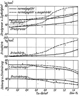
Abb. 99. Einfluß von Kupfer auf die Festigkeitseigenschaften normalgeglühter, sowie normalgeglühter und ausgehärteter, 10 mm dicker Bleche aus Stahl mit 1% Cr und 0,1% C (Williams und Lorig).
