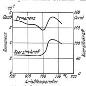
Abb.115. Änderung von Remanenz und Koerzitivkraft beim Anlassen (1 Stunde) einer von 1250° in Wasser abgeschreckten Legierung mit 14 % Ni, 16 % Cu und 15 % Co (Legat).
