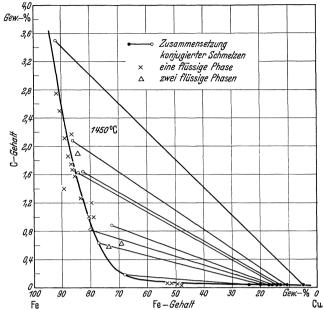
Abb. 6. Gleichgewicht des Fe-Cu-C-Systems im flüssigen Zustand bei 1450° (I was é und Mitarbeiter).
