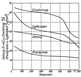
Abb. 34. Festigkeitseigenschaften von austenitischem Stahl mit 0,1% C, 18% Cr, 8% Ni, 0,5% Ti und 3% Cu in Abhängigkeit von der Temperatur (Fried. Krupp A.G.).
