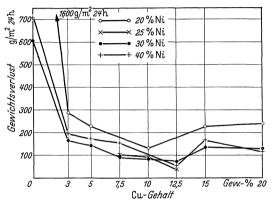
Abb. 65. Einfluß von Kupfer auf die Beständigkeit von Eisen-Nickel-Legierungen mit: 3 % Si in 10 % iger siedender Schwefelsäure (Miller).
