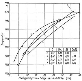
Abb. 132. Flüssigkeitsgrad von weichem Kohlenstoffstahl und kupferlegiertem Stahl in Abhängigkeit von der Temperatur (Sarjant und Middleham).
