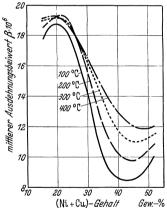
Abb. 161. Einfluß eines Nickel- und Kupfer-Gehaltes (Verhältnis 2:1) auf die Wärmeausdehnung von Grauguß (Wood).
