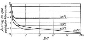
Abb. 110. Änderung des elektrischen Widerstandes der von 1000° abgeschreckten Eisen-Nickel-Kupfer-Legierung mit 13,1% Cu beim Anlassen (Bumm und Müller).
