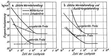
Abb. 137a und b. Biegewechselfestigkeit und Schadenlinie von Ford-Kurbelwellenguß, ermittelt an glatten und scharf gekerbten Proben verschiedener Vorbehandlung (Russel).
