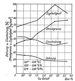
Abb. 23. Einfluß von Kupfer auf die Festigkeits-eigenschaften von Stahl mit 0,4% C im normal-geglühten Zustand (Williams und Lorig).
