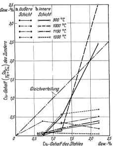
Abb. 67. Abhängigkeit des Kupfergehaltes der Zunderschichten vom Kupfergehalt des Stahls bei verschiedenen Zundertemperaturen (Scheil und Kiwit).
