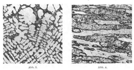
Abb. 3 und 4. Gefüge einer Legierung mit 50% Cu und 50% Fe im gegossenen (Abb. 3) und geschmiedeten Zustand (Abb. 4). V=200 (Schuhmacher und Souden).
