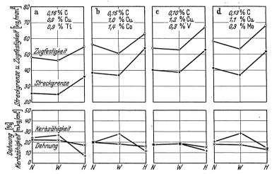
Abb. 95 a bis d. Festigkeitseigenschaften kupferlegierter Stähle mit Mo-, V-, Co- und Ti-Zusatz im normalisierten (N), weichgeglühten (W) und anlaßgehärteten (H) Zustand (Rädeker).
