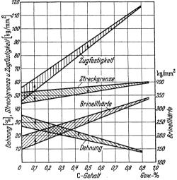
Abb. 84. Festigkeitseigenschaften von Stählen mit verschiedenen C-Gehalten und 1,5% Cu, normalgeglüht und ausgehärtet nach voraufgegangener Normalglühung (Williams und Lorig).
