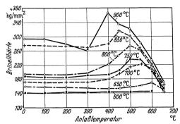
Abb. 75. Einfluß des Anlassens auf die Härte einer 5%igen Eisen-Kupfer-Legierung nach Abschrecken von verschiedenen Temperaturen (Buchholtz und Köster).
