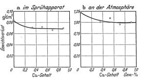
Abb. 156 a und b. Ergebnisse von Bewitterungsversuchen an gekupfertem Gußeisen (Kötzschke und Piwowarski).
