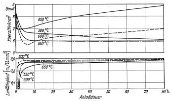
Abb. 76. Zeitliche Änderungen von Leitfähigkeit und Koerzitivkraft einer von  $900^\circ$  abgeschreckten,  $5\,\%$ igen Kupfer-Eisen-Legierung bei verschiedenen Anlaßtemperaturen (Buchholtz und Köster).
