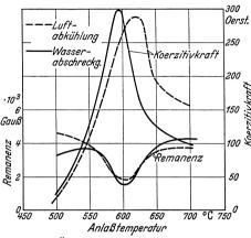
Abb. 114. Änderung von Remanenz und Koerzitivkraft beim Anlassen (1/2 Stunde) einer von 1250° unterkühlten Legierung mit 15% Ni und 14% Cu (Legat).
