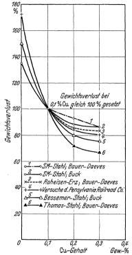
Abb. 47. Einfluß des Kupfergehaltes von Stahl auf den Gewichtsverlust an der Atmosphäre (Daeves).
