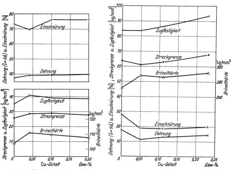
Abb. 19. Einfluß geringer Kupfergehalte auf die Festigkeitseigenschaften normalisierter Stähle mit rund 0,1% C. (1 Stunde bei 930° geglüht, Luftabkühlung.) (Bennek.)
