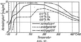
Abb. 96 und 97. Kerbzähigkeit von kupferlegiertem Stahl in Abhängigkeit von Temperatur und Ausscheidungszustand. Probeabmessung:  $10\times10\times60$  mm, Schlagquerschnitt  $10\times7$  mm, Kerbdurchmesser 2 mm (Rädeker).
