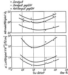
Abb. 146. Einfluß von Kupfer auf die elektrische Leitfähigkeit und die Wärmeleitfähigkeit von Gußeisen mit 3% C und 2,3% Si (Söhnehen und Piwowarski).
