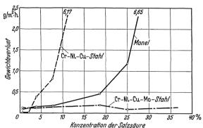
Abb. 63. Beständigkeit von Kupfer und Kupfer + Molybdän enthaltenden, austenitischen Chrom-Nickel-Stählen, sowie von Monelmetall gegen Salzsäure bei Raumtemperatur (Houdremont).
