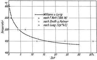
Abb. 79. Beziehung zwischen Aushärtungstemperatur und Zeit bis zum Erreichen der Höchsthärte.
