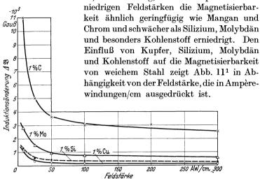
Abb. 11. Einfluß von Kohlenstoff, Molybdän, Silizium und Kupfer auf die Magnetisierbarkeit von weichem Stahl (Gerold).
