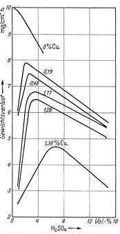
Abb. 157. Widerstandsfähigkeit von Gußeisen mit verschiedenen Kupfergehalten gegen den Angriff durch verdünnte Schwefelsäure bei Raumtemperatur (Maréchal).
