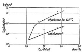
Abb. 74. Einfluß des Kupfergehaltes auf die Zugfestigkeit von Stahl im unbehandelten und angelassenen Zustand (Nehl).
