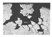
Abb. 14. Rotbruch durch Bronze bei 850°. Stab mit 1,2% C und 3,4% Mn nach dem Biegen in Wasser abgeschreckt; Bruch in den Korngrenzen des Austenits (Schottky, Schichtel und Stoile).
