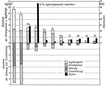
Abb. 121. Wirkung und Kosten von Legierungszusätzen in einem Baustahl mit 0,1% C (Schulz und Buchholtz).
