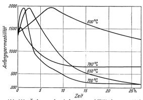
Abb. 111. Änderung der Anfangspermeabilität der von 1000° abgeschreckten Eisen-Kupfer-Nickel-Legierung mit 13,1% Cu beim Anlassen (Bumm und Müller).
