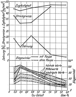
Abb. 42. Festigkeitswerte lichtbogengeschweißter Proben (Ze yen und Mehl).
