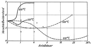
Abb. 87. Verschleißzahlen (Spindel) von Schienenstahl mit 1 % Cu in Abhängigkeit von der Anlaßdauer und Anlaßtemperatur (Lueg).
