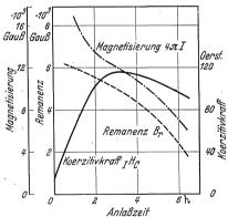
Abb. 119. Änderung der magnetischen Eigenschaften einer Eisen-Nickel-Kupfer-Legierung mit 15 % Ni und 10 % | Cu beim Anlassen bei 600° (Da n'nöhl).
