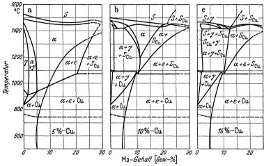
Abb. 9a bis c. Schnitte durch das Dreistoffsystem Eisen-Kupfer-Molybdän bei gleichbleibendem Kupfergehalt (Dannöhl).
