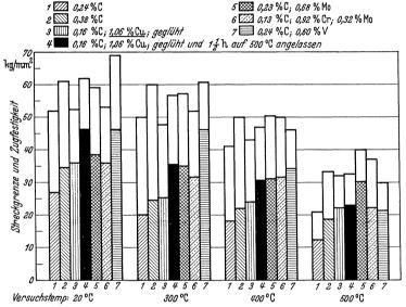
Abb. 136. Warmfestigkeit von verschieden legiertem Stahlguß (Nehl und Rys).
