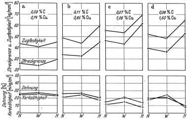
Abb. 92 a bis d. Festigkeitseigenschaften von Kupferstählen im normalisierten (N), weichgeglühten (W) und anlaßgehärteten (H) Zustand (Rädeker).
