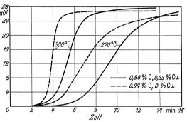
Abb. 38. Einfluß von Kupfer auf die Umwandlungsgeschwindigkeit des Austenits (Zeit-Magnetisierungskurven) bei 270 und 300°.
