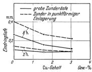
Abb. 68. Einfluß des Kupfergehaltes im Stahl auf das Eindringen von Zunder bei 1200° in oxydierender Atmosphäre (Schrader).
