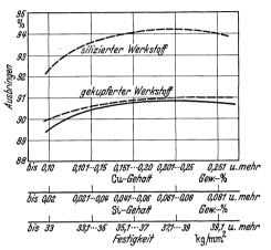
Abb. 18. Einfluß des Cu- und Si-Gehaltes auf das Kleben (ausgedrückt durch das Ausbringen) von Feinblechen (Andrieu).
