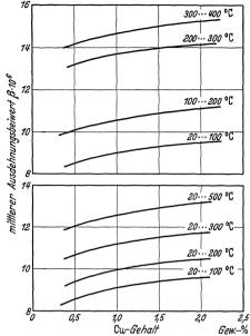
Abb. 147. Einfluß von Kupfer auf den mittleren Ausdehnungskoeffizienten von Gußeisen mit 3% C und 2,3% Si (Söhnchen und Piwowarski).
