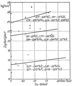
Abb. 151. Einfluß von Kupfer auf die Zugfestigkeit von Gußeisen verschiedener Festigkeit (Pfannenschmidt). (Auswertung Verfasser.)
