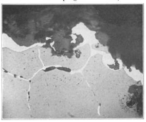
Abb. 15. Kupferschicht (weiß) zwischen Zunder und Metalloberfläche eines Kupferstahls (Nehl).
