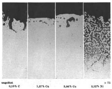
Abb. 69. Beschaffenheit der Randzone von Kohlenstoff-, Kupfer- und Nickelstahl nach 8stündigem Glühen bei 1200° in oxydicrender Atmosphäre (Schrader).
