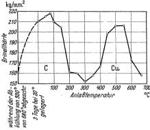
Abb. 85. Einfluß der Anlaßtemperatur bei halbstündigem Anlassen auf die Härte eines an Kohlenstoff und Kupfer gleichzeitig übersättigten Stahls (Buchholtz und Köster).
