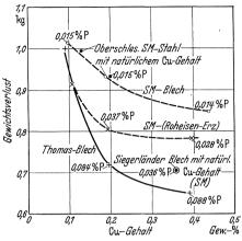
Abb. 50. Einfluß des Kupfergehaltes auf das Verrosten an der Luft. (Nach Daeves, Werte nach Bauer.)
