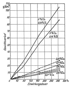
Abb. 56. Gewichtsabnahme von Stählen mit 0,016% S und 0,16% P in  $\frac{n}{5}$ -Salzsäure (Bardenheuer und Thanheiser).
