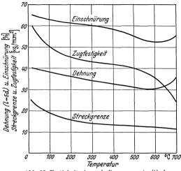
Abb. 35. Festigkeitseigenschaften von austenitischem Stahl mit 0,1 % C, 18 % Cr, 18 % Ni, 2 % Mo, 0,5 % Ti und 2 % Cu in Abhängigkeit von der Temperatur (Fried. Krupp A.G.).
