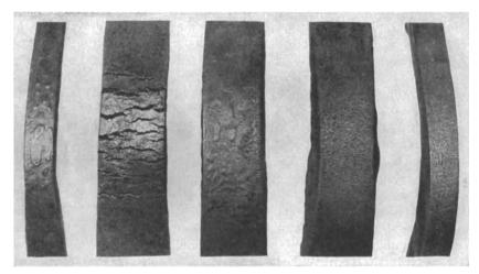
Abb. 16. Kupfer- und Kupfer-Nickel-Stähle, 24 Stunden auf 1200° C erhitzt und gebogen (Rädeker), 0,5% Cu. 1,0% Cu. 0,8% Cu; 0,5% Ni. 1,0% Cu; 3,0 % Ni. 1,0% Cu; 2,4% Ni.
