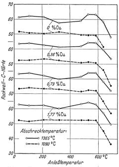
Abb. 131. Härte von kupferhaltigem Schnelldrehstahl beim Anlassen nach Abschrecken von 1090° und 1365° (French und Digges).
