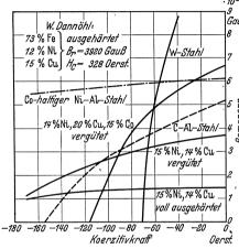
Abb. 120. Entmagnetisierungskurven einiger technisch gebräuchlicher Dauermagnetlegierungen und einiger ferritischer Nickel-Kupfer-Legierungen (Legat).
