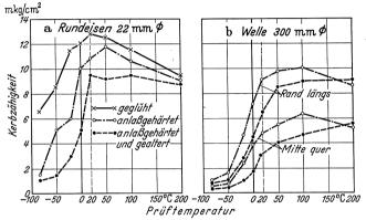
Abb, 127a und b. Einfluß der Anlaßhärtung und einer zusätzlichen Alterungsbehandlung auf die Kerbzähigkeit von geschmiedetem Chrom-Kupfer-Stahl (Buchholtz und Köster).
