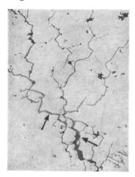
Abb. 13. Unterer Teil eines Risses infolge Rotbruch durch Kupfer. (Die Zwischenräume der durch die Risse getrennten Körner sind mit Kupfer gefüllt) (Schottky, Schichtel und Stolle).
