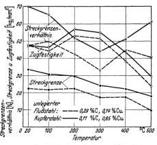
Abb. 29. Festigkeitseigenschaften geglühter 20 mm-Bleche bei höheren Temperaturen (Nehl).
