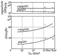
Abb. 148. Einfluß von Kupfer auf die magnetische Sättigung und die Güteziffer  $(\mathfrak{B}_T \times \mathfrak{H}_e)$  von Gußeisen mit 3% C und 2,3% Si (Söhnchen und Piwowarski).
