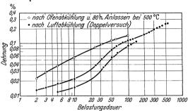
Abb. 106. Zeit-Dehn-Verlauf eines Si-Mn-Cu-Stahles bei 500° und 9 kg/mm² Zugbeanspruchung (Grün).
