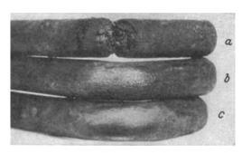
Abb. 12. Verkupferte Stäbe ober- und unterhalb des Kupferschmelzpunktes gebogen; Stahl mit 0,1% C. a bei 1125° gebogen, b bei 1090° gebogen, c bei 1075° gebogen (Schottky, Schichtel und Stolle).
