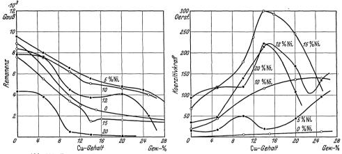
Abb. 116. Remanenz und Koerzitivkraft von ausgehärteten Eisen-Kupfer- und Eisen-Kupfer-Nickel-Legierungen in Abhängigkeit vom Kupfergehalt (Legat).
