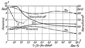
Abb. 118. Einfluß von Kohlenstoff, Silizium und Mangan auf die Remanenz und Koerzitivkraft eines Ni-Cu-Stahls mit 15% Ni und 15% Cu im ausgehärteten Zustand (Legat).
