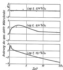
Abb. 113. Änderung des spezifischen elektrischenWiderstandes von 1000° abgeschreckter Eisen - Nickel - Kupfer - Legierungen beim Anlassen bei 500° (Bumm und Müller).
