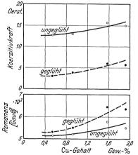
Abb. 149. Remanenz und Koerzitivkraft von Sandguß mit 3% C und 2,3% Si in Abhängigkeit vom Kupfergehalt (Söhnchen).
