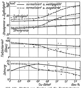
Abb. 100. Einfluß von Kupfer auf die Festigkeitseigenschaften und die Tiefziehbarkeit weichgeglühter, sowie normalgeglühter und anschließend ausgehärteter, 1,1 mm dicker Bleche aus Stahl mit 1% Cr und 0,1% C (Williams und Lorig).
