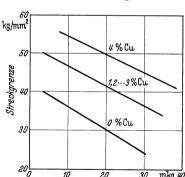
Abb. 24. Beziehung zwischen Streckgrenze und Charpy-Schlagarbeit bei weichge-glühten Stählen mit 0,02 bis 0,43% C und 0 bis 4% Cu (Williams und Lorig).
