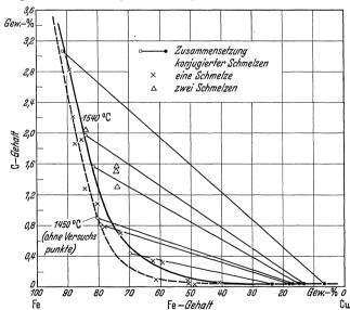
Abb. 7. Gleichgewicht des Fe-Cu-C-Systems im flüssigen Zustand bei  $1540^\circ$  (I was  $\acute{e}$  und Mitarbeiter).
