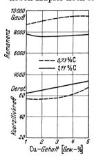
Abb. 10. Remanenz und Koerzitivkraft von Stählen mit 0,7 und 1,1% C nach Abschrecken von 800° in Wasser in Abhängigkeit vom Kupfergehalt (Stogoff und Messkin).
