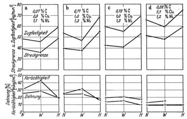
Abb. 93 a bis d. Festigkeitseigenschaften von Kupfer-Nickel-Stählen im normalisierten (N), weichgeglühten (W) und anlaßgehärteten Zustand (Rädeker).
