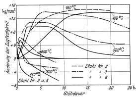
Abb. 101. Einfluß der Anlaßtemperaturfund Dauer auf die Änderung der Zugfestigkeit der unterkühlten Stähle 2, 3 und 5 nach Zahlentafel 35 (Faure).
