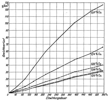
Abb. 55. Gewichtsabnahme von Proben aus Thomasstahl in  $\frac{n}{5}$ -Salzsäure (Bardenheuer und Thanheiser).
