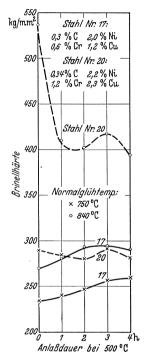
Abb. 104. Einfluß der Normalisierungstemperatur und der Anlaßdauer bei 500° auf die Brinellhärte von Nickel-Kupfer-Chrom-Stählen (Harrison).
