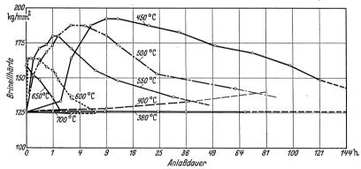
Abb. 78. Brinellhärte eines Kupferstahles mit 1% Cu in Abhängigkeit von der Anlaßdauer bei verschiedenen Anlaßtemperaturen (Nehl).
