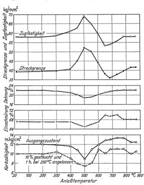
Abb. 126. Einfluß der Anlaßtemperatur bei einstündiger Anlaßdauer auf die mechanischen Eigenschaften eines geglühten Chrom-Kupfer-Stahls (Buchholtz und Köster).
