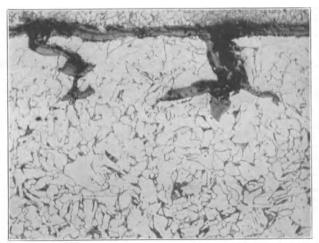
Abb. 71. Schnitt durch die rissige Oberfläche nach Abb. 70 (rund ×100) (Nehl).
