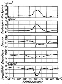
Abb. 81. Festigkeitseigenschaften eines Stahls mit 0,08% C und 1,0% Cu in Abhängigkeit von der Anlaßtemperatur (Nehl).
