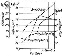
Abb. 153. Einfluß von Kupfer auf die Festigkeitswerte von Kupolofen-Eisen mit 3,5 °C, 1,48 °Si, 0,45 °Mn; 0,26 °P und 0,09 °S (Schnee).
