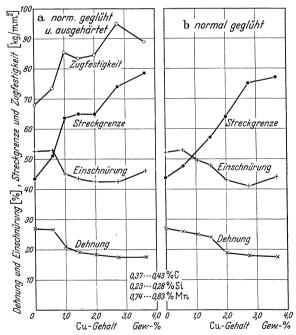
Abb. 83 a und b. Festigkeitseigenschaften von normalgeglühten und ausgehärteten Stählen mit  $0.4\,\%$  C und verschiedenen Kupfergehalten (Williams und Lorig).
