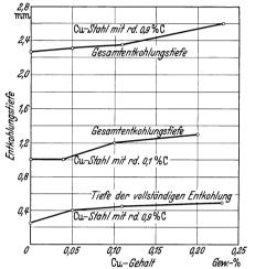
Abb. 17. Randentkohlung in oxydierender Atmosphäre bei 1250° C. (Glühdauer 1 Stunde.)
