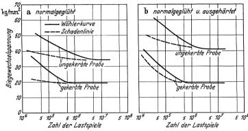
Abb. 135a und b. Einfluß der Aushärtung auf die Dauerfestigkeit und die Lage der Schadenslinie von Stahlguß mit 0.23 % C und 1.2 % Cu (Russel).
