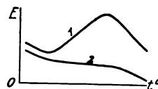
Abb. 16. Abhängigkeit des Elastizitätsmoduls E von der Temperatur t nach GUILLAUME: 1 für reines Invar, 2 für Elinvar.
