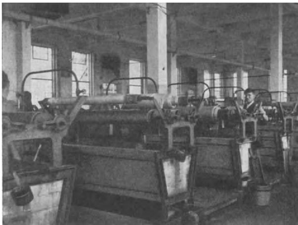
Abb. 127. Inneres der Stückfärberei Abb. 126. Die drei Frischlufteintrittsöffnungen sind links als dunkle Stellen erkennbar.
