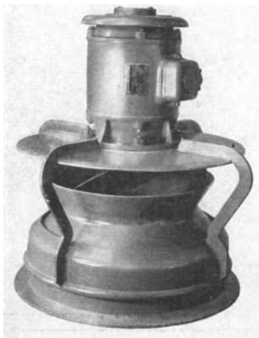
Abb. 42. Propellerlüfter mit geschlossenem Antriebsmotor, geeignet zum Aufsetzen auf Abluftschächte im Freien, bei säurefester Ausführung auch verwendbar zum Absaugen säurehaltiger Luft, von Rauchgasen usw.
