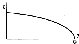
Abb. 26. Verdampfungswärme l als T -Funktion von T nach VAN DER WAALS-KOHNSTAMM.
