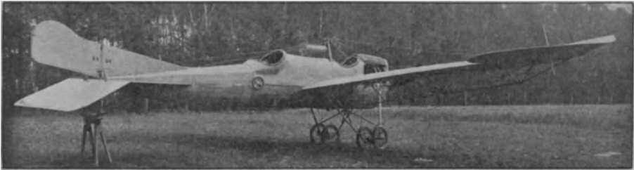
Fig. 39. Antoinette-Typ. Schwerpunkt im Winkelscheitel, Kielflosse. Deutsche Flugzeugwerke.
