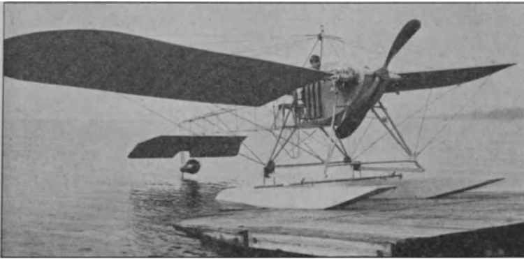
Fig. 38. Antoinette-Typ. Tiefe Schwerpunktslage. Flugzeugbau Friedrichshafen. (Kober.)
