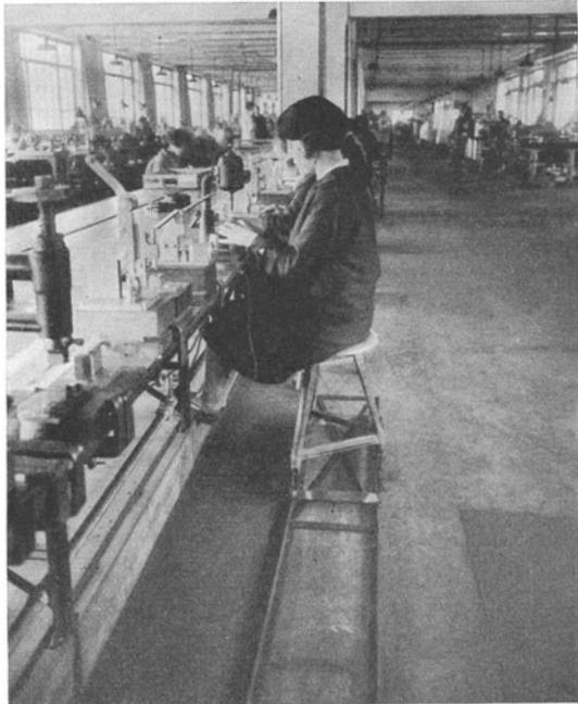
Abb. 21. Fahrbarer Schemel zur Bedienung mehrerer Arbeitsplätze.
