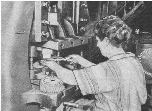
Abb. 38. Maschine ohne Unfallschutz.
