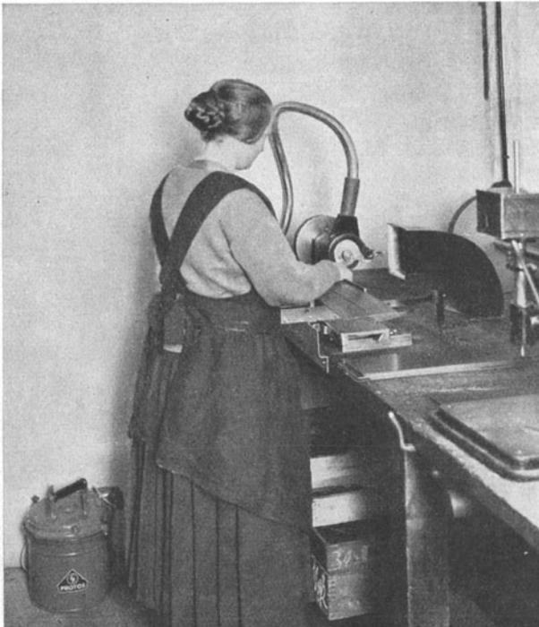
Abb. 45. Protos-Staubsauganlage.
