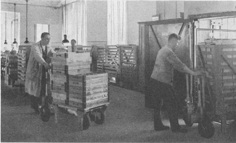
Abb. 9. Transportkästen auf Hubkarren. Die eisernen Ecken ermöglichen rechtwinkliges Stapeln und staubdichte Abdeckung.
