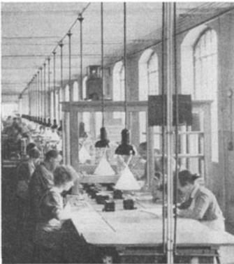
Abb. 16. Eingliederung von Prüfständen in das fließende Band.
