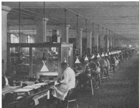
Abb. 17. Hochspannungsprüfung von Apparaten am Fließband. Die Stromzuführungen sind nur dem Prüfer zugänglich.
