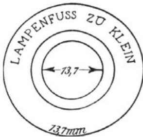
Abb. 3. Hilfslehre für den Lampenfuß.
