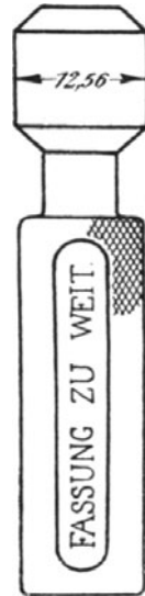
Abb. 4. Hilfslehre für die Fassung.
