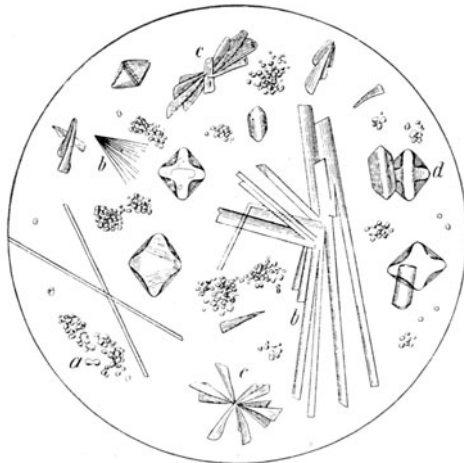
Abb. 129. a kohlensaurer, b schwefelsaurer Kalk, c neutraler phosphorsaurer Kalk, d basisch phosphorsaure Magnesia (nach v. Jaksch).
