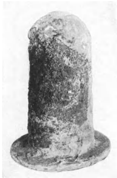
Abb. 159. Salzbadtiegel auf Außenseite durch Salz korrodiert. (Nach Ziegler.)
