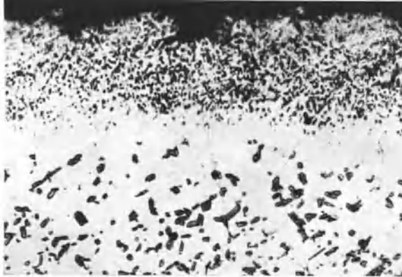
Abb. 133. Eisen mit 30% Cr und 5% Al 5 \frac{1}{2} Stunden bei 1400° C in Stickstoff geglüht (Nähe der Oberfläche).
