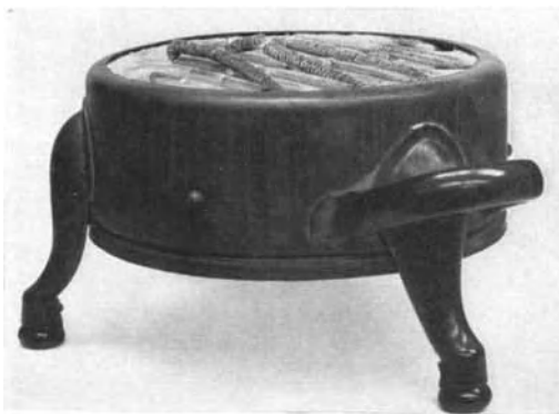
Abb. 202. Verwerfen dünner Heizspiralen aus Cr-Al-Fe-Legierungen in offenen Kochplatten.
