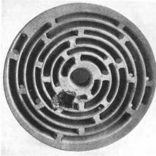
Abb. 177. Durch Lichtbögen zerstörte Heizplatte.
