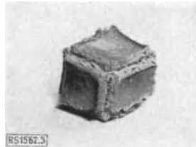
Abb. 6. Verzunderungsprobe aus Wolfram (Scheil).
