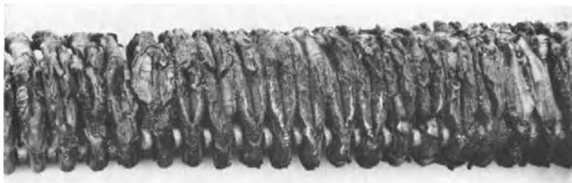
Abb. 163. Heizwendel aus Glasurbrennofen ( \frac{2}{3} nat. Größe).
