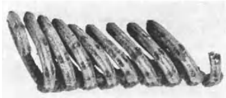
Abb. 164. Cr-Ni-Heizwendel mit aufgefallenem Oxyd.
