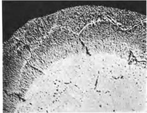
ungeätzt × 60 Abb. 158. Zerstörung eines Thermoelements (Cr-Ni-Schenkel) durch Salznebel.
