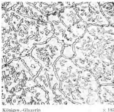
Abb. 113. Eisenfreies Chrom-Nickel in Leuchtgas bei 1050° C geglüht.
