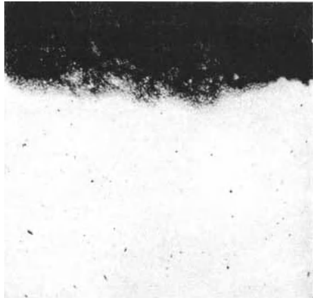
Abb. 226. Cr-Ni-Schenkel eines Thermolementes 10 Minuten bei 700° C in Schwefelwasserstoff geglüht.
