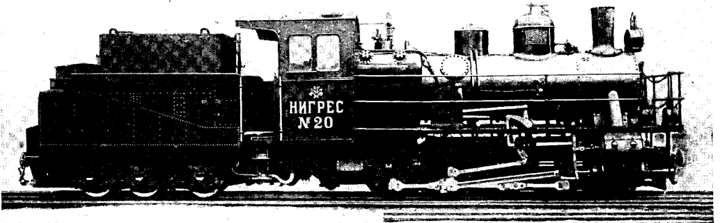
Товаро-пассажирский П. узкой колеи Коломенского завода типа 0-4-0 с трехосным тендером.
