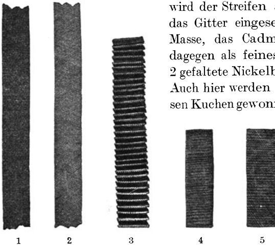
Abb. 86. 1. Reinnickelstreifen, gewalzt. 2. Reinnickelstreifen, perforiert. 3. Gewellter Streifen. 4. Gefalzter Streifen. 5. Gepreßter Kuchen.
