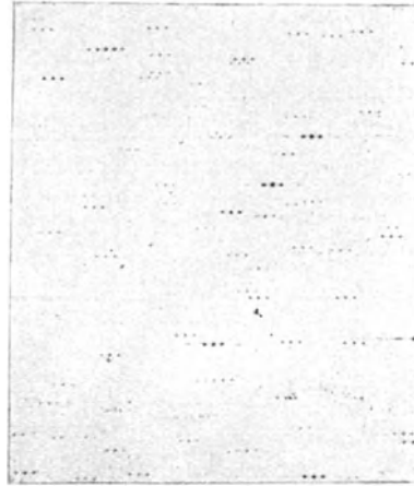
Abb. 23. Sternaufnahmen mit Objektivgitter: Zentralbilder mit Beugungsspektren auf beiden Seiten. Nach Lindblad .
