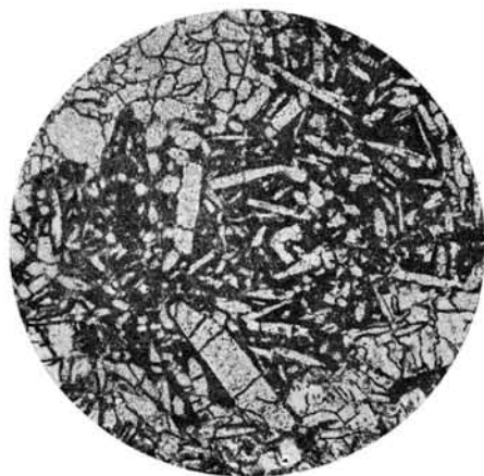
Рис. 6. Пятно с неориентированным распределением кристаллов апатита. Цементирует эгириин-авгит. Структура пойкилитовая. Никольи. \times 16 .
