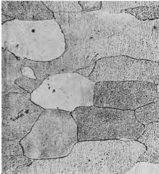
Abb. 62. Gefüge des reinen Eisens (Ferrit).
