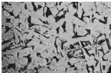
Abb. 65. Fe-C-Legierung mit 0,27% C (Ferrit + Perlit) \times 100.
