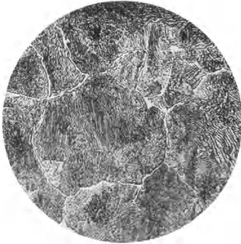
Abb. 69. Fe-C-Legierung mit 1,5% C (Perlit + Zementit) \times 100 .
