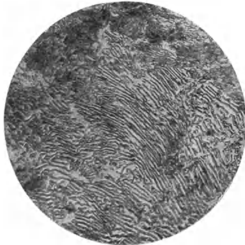
Abb. 67. Lamellarer Perlit ( \times 400 ).
