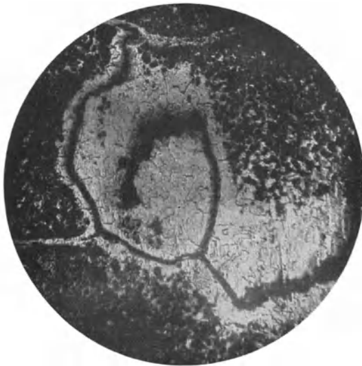
Abb. 231. Entkohlung längs Härterissen. \times 500 .
