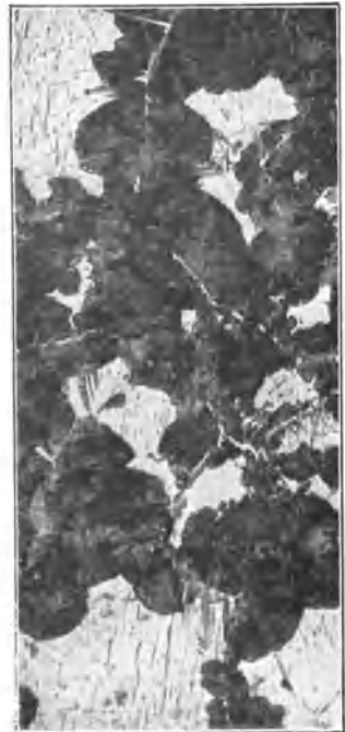
Fig. 54. Schwarze Troostitflecke in martensitischer Grundmasse. Reste von Zementit. 200 mal.
