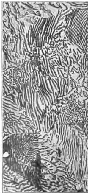
Fig. 51. Streifiger Perlit mit 0,9%. 600 mal.
