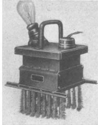
Abb. 9. Einfacher Rechen-Elektromagnet.
