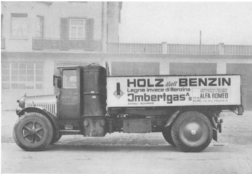
Abb. 45. Start des Wagens 55 zur Alpenwertungsfahrt in Innsbruck am 22. September 1934: Berna-5-t-Lastwagen mit Imbert-Holzgas (Generator hinter Führerhäuschen)
