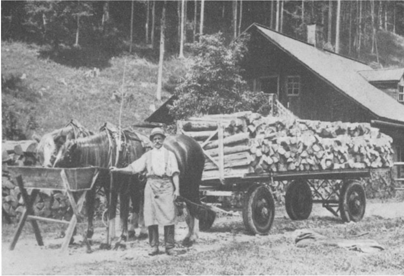
Abb. 30. Luftgummibereifter Pferdewagen mit Gestell aus Eisen (im Bundesforst Ebensee, Oberösterreich)
