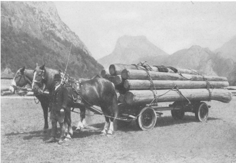
Abb. 31. Luftgummibereifter Pferdewagen mit Gestell aus Holz (im Bundesforst Ebensee, Oberösterreich)
